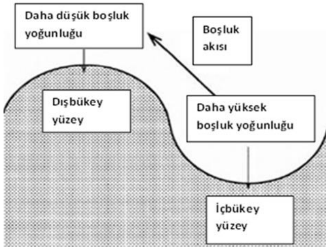
Şekil 2.15. Kavisli bir yüzeydeki boşlukların akış yönlerinin şematik gösterimi [4]
