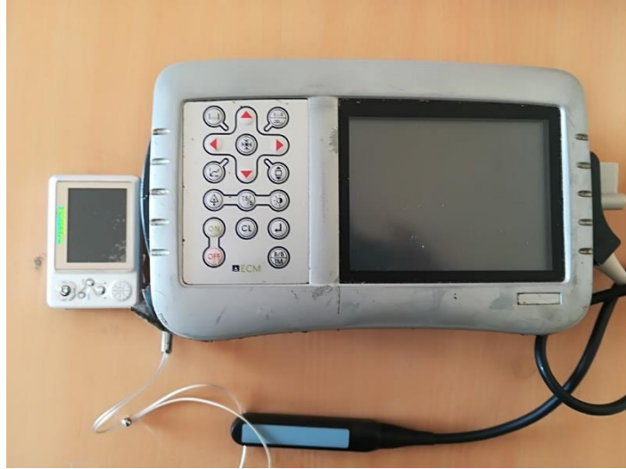
Şekil 39. Çalışmada kullanılan ultrason (AgroscanAL ® , Noveko International Inc., Angoulême, France) ve dijital görüntü kayıt cihazı (PMP-100 ® , Sigmatek, France)
