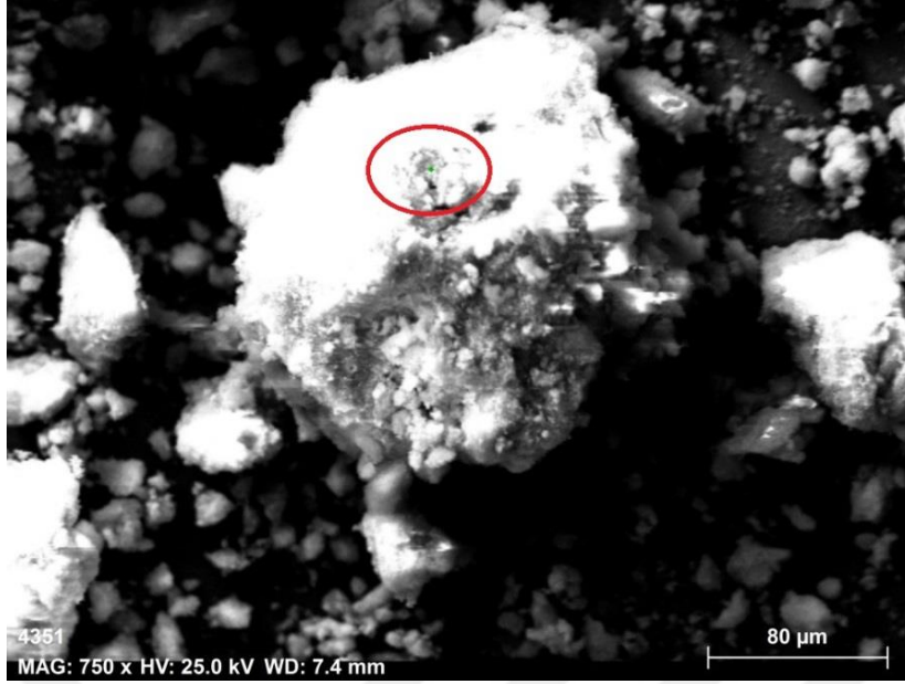
Şekil 5-8. Hidroksiapatitin adsorpsiyon sonrası EDX analizi için alınan SEM görüntüsü
