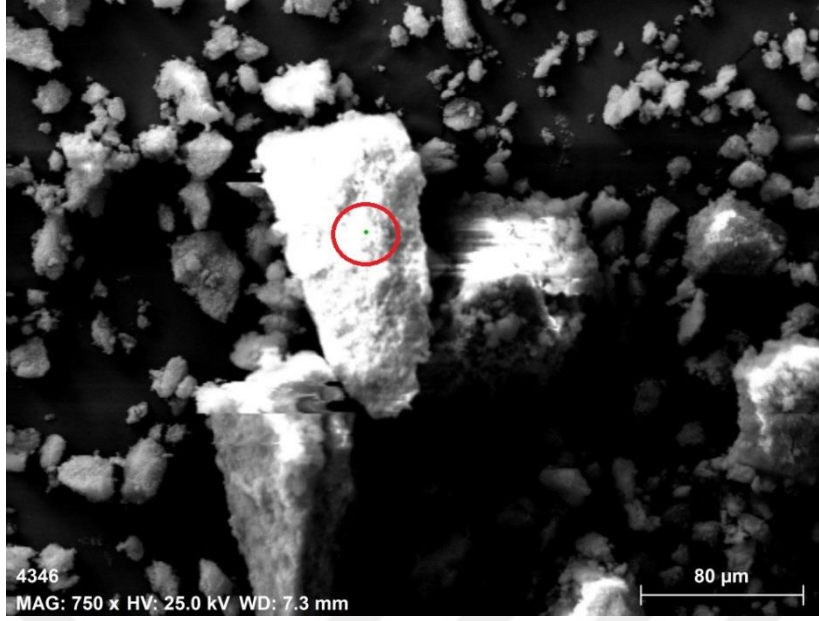
Şekil 5-6. Hidroksiapatitin adsorpsiyon öncesi EDX analizi için alınan SEM görüntüsü
