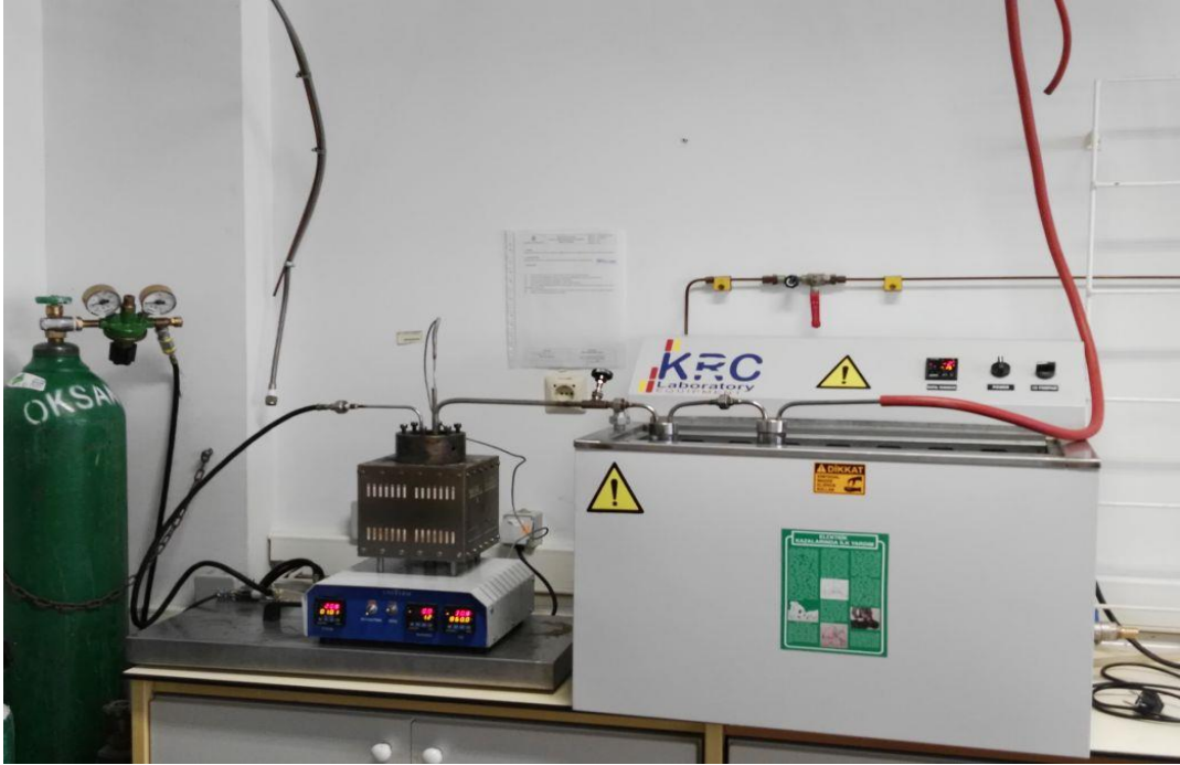
Şekil 3.5. Kızılçık çekirdeğinden aktif karbon üretimi için kullanılan karbonizasyon düzeneği
