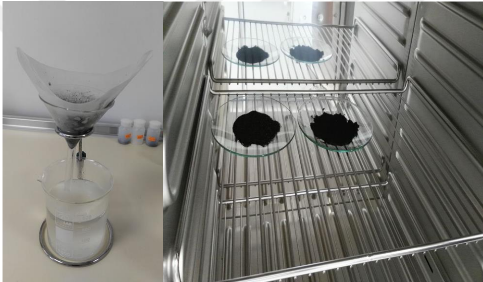
Şekil 3.7. Karbonizasyon sonrası yıkama işlemi ve etüvde kurutma işlemi
