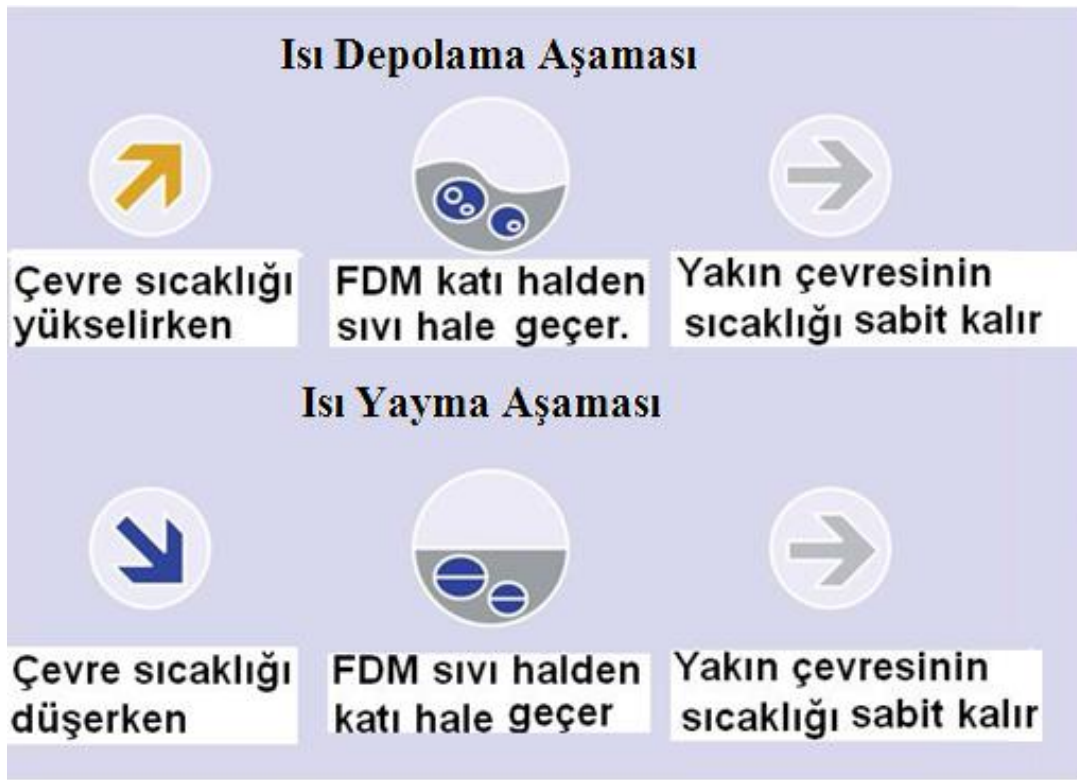
Şekil 2.3. Faz değişim malzemelerinin ısıyı depolama ve yayma çevrimi.
