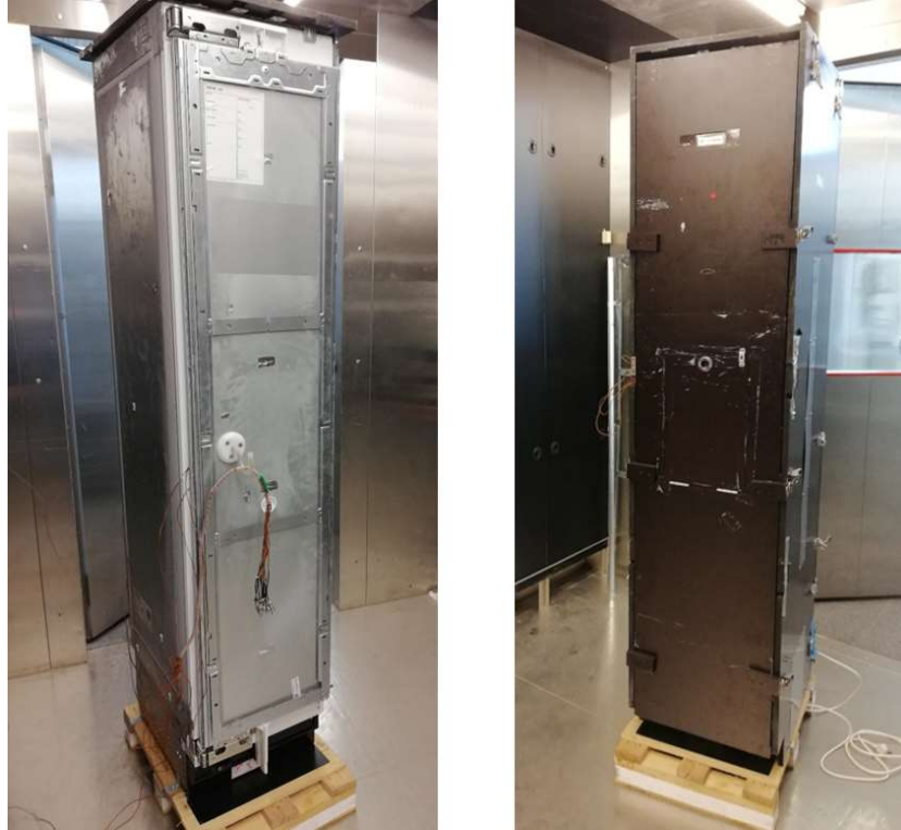
Şekil 5.1 : Ahşap panel montajı öncesi ve sonrası dondurucu görüntüsü.
