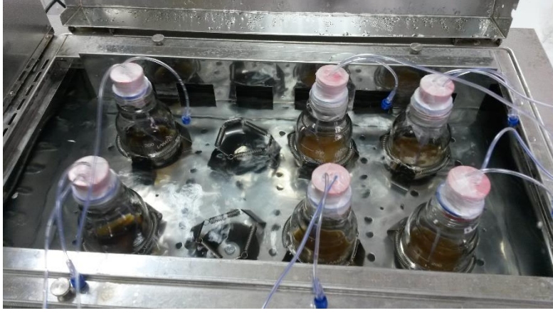
Şekil 3.8. Etanol fermantasyon düzeneği
