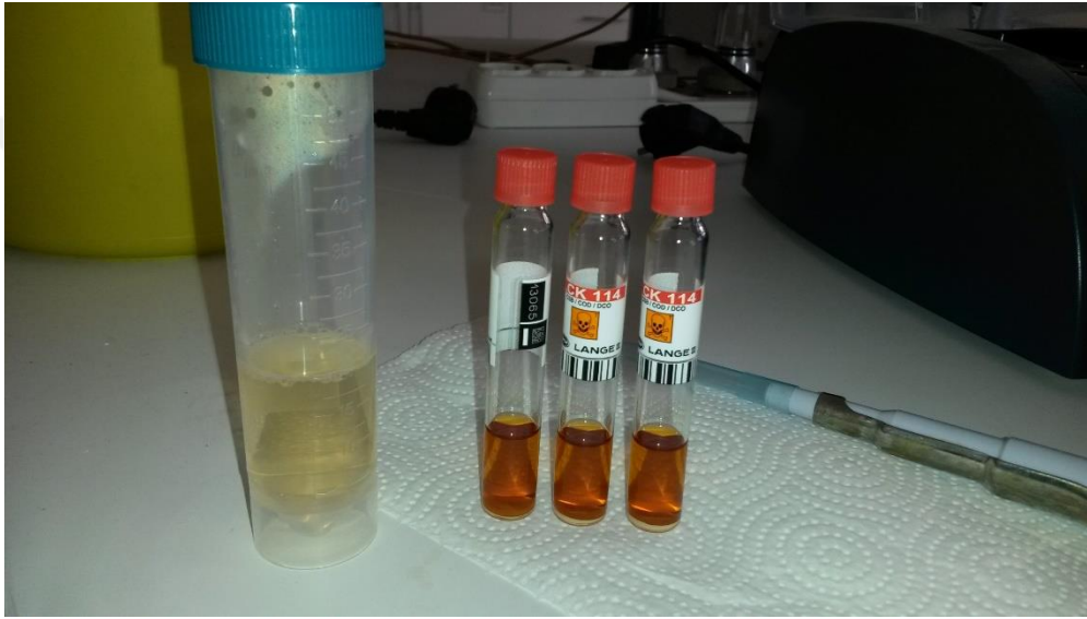
Şekil 3.2. \text{çKOİ} analizi için santrifüjlenmiş numune ve Hach- Dr. Lange hazır test kitleri
