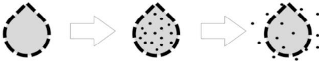
Şekil 3.1: Difüzyon kontrollü sistemlerde ilacın salınması [24].
