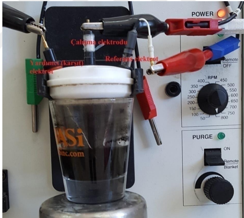
Şekil 3.12. Üçlü elektrot sistemine sahip olan elektrokimyasal hücre (BAS, Inc, USA).
