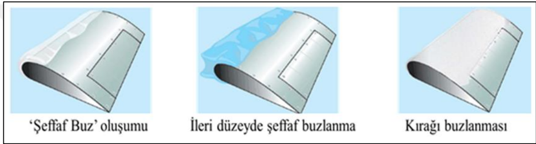
Şekil 2.6: Uçakların kanatlarında gözlenen buzlanma oluşumları.
