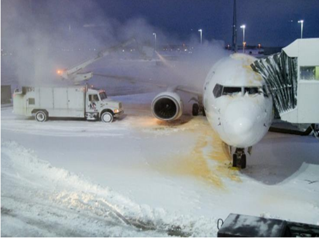
Şekil 2.10: Buz çözme işlemi sırasında kar yüzeylerinde BÇS birikimi.
