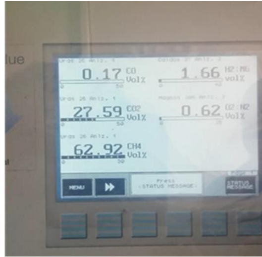
Şekil 4.46: Tip I - saf su (%1,37 BÇS) reaktöründeki biyogaz karakteristiği.
