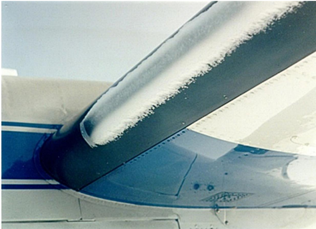
Şekil 2.7: Uçağın kanadında görülen buzlanma.
