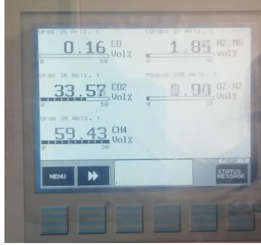
Şekil 4.47: Tip II - saf su (%1,76 BÇS) reaktöründeki biyogaz karakteristiği.
