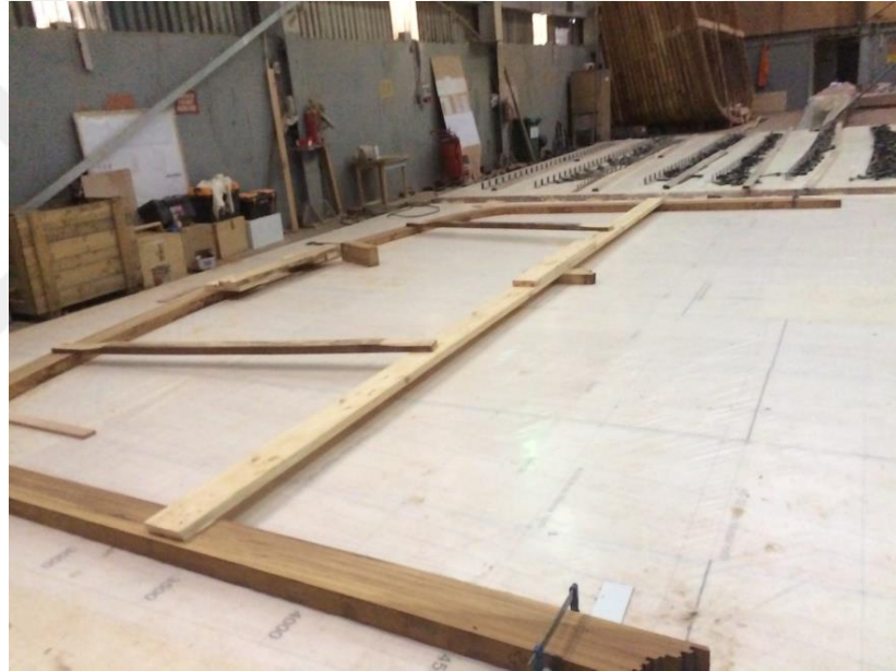
Resim 2. 5 Postaların yapım aşaması. Ahşap konstrüksiyonlu teknenin iskeletini oluşturmada kullanılan boyuna elemanlar olan postaların yapım aşamasına ait fotoğraf. Fotoğrafta tekne yapımı için hazırlanan 1-1 şablonun üzerinde şablona göre kesilen posta yer almaktadır. Fotoğraf İstanbul Tuzla’da bulunan Tansu Yatçılık’ta çekilmiştir (Yazar arşivi, 2018).
