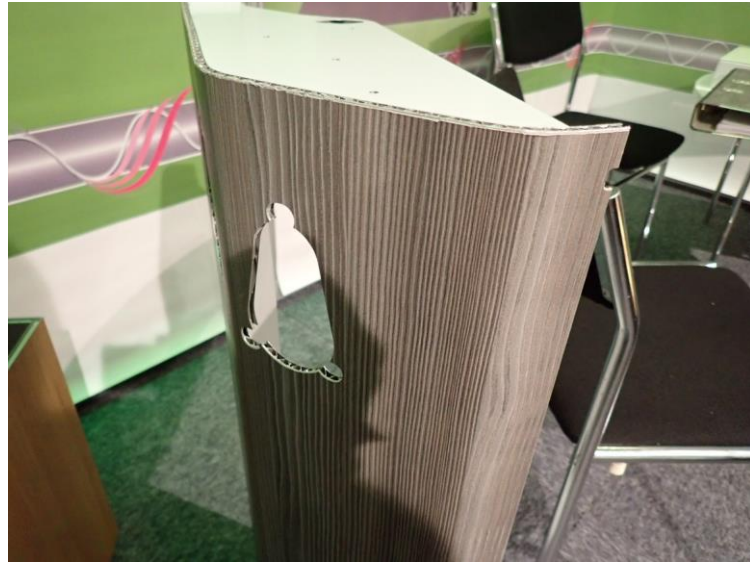
Resim 2. 27 Alüminyum panel. Metawell marka alüminyum panele ait fotoğraf. Fotoğraf 2017 RAI METSTRATE Hollanda fuarında çekilmiş olup, fotoğrafın çekildiği sırada basit el aletleriyle panele şekil verildiği gözlemlendi (Yazar arşivi, 2017).
