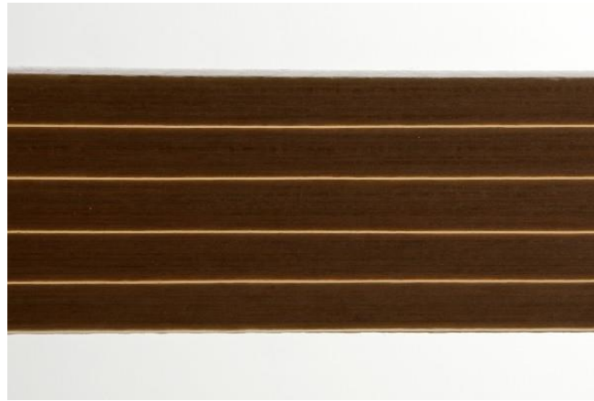
Resim 2. 31 Reçine çizgili laminat. Fotoğrafta laminat dekoratif yüzeyin arasında bulunan şeffaf reçineden yapılmış çizgiler bulunmaktadır. Çizgilerden ışık geçirgenliği sağlandığı görülmektedir (URL 33).
