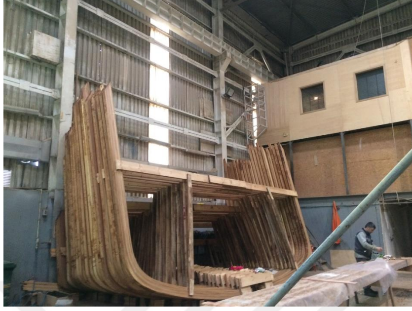
Resim 2. 6 Birleştirilmeye başlanan postalar. Ahşap konstrüksiyonlu teknenin iskeletini oluşturmada kullanılan boyuna elemanlar olan postaların yapım aşamasına ait fotoğraf. Fotoğrafta hazırlanan postalar omurgaya birleştirilerek teknenin strüktürü oluşturulmaya başlanmaktadır. Fotoğraf İstanbul Tuzla’da bulunan Tansu Yatçılık’ta çekilmiştir (Yazar arşivi, 2018).
