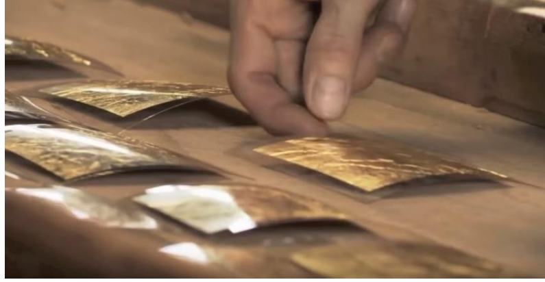
Resim 2. 48 Altın mozaiklerin üretim süreci. Fotoğrafta altın yapraklar bulunmaktadır (URL 51).
