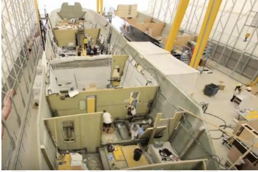
Resim 2. 26 40m uzunluğunda süperyat olarak anılan ‘Princess’ e ait fotoğraf. Princess, Amerika’da bulunan Princess Yachts tarafından 2012 yılında inşa edilmiştir. Mekan bölücü duvarların uygulanma aşaması görülmektedir (URL 28).
