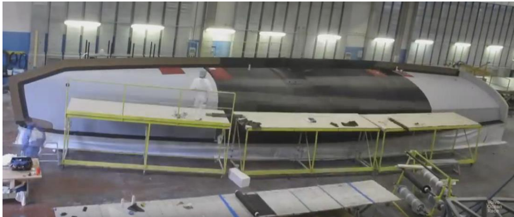
Resim 2. 13 Kalıbın üzerine kompozit malzeme serilme aşaması. Farr Yacht Design tarafından infüzyon tekniğiyle yapılmakta olan karbon kompozit konstrüksiyonlu yata ait fotoğraf. Fotoğrafta kalıbın üzerine karbon fiber serilmektedir (URL 15).
