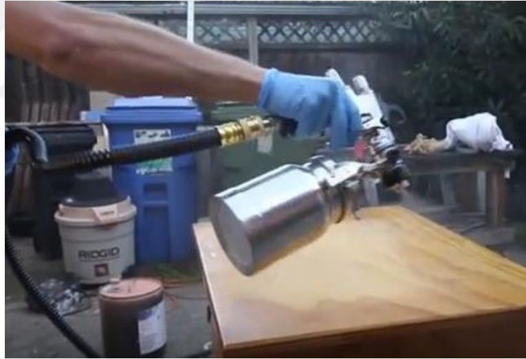
Resim 2. 73 Lake uygulaması. Fotoğrafta lake uygulaması HVLP sprey sistemiyle gerçekleştirilmektedir (URL 82).
