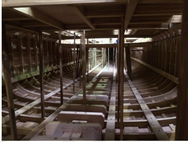
Resim 2. 8 Ahşap strüktür gövdeye içten bakış. Ahşap konstrüksiyonlu teknenin iskeletinin ana elemanı olan omurga, boyuna elemanlar olan postalar, postaların darbelere karşı daha dayanıklı olmasını sağlayan şiyer kuşakları ve taban kirişlerine ait detay fotoğrafı. Fotoğrafın çekildiği aşamada strüktürü tamamlanan teknede armuz sistemi ile konstrüksiyon oluşturulmaktadır. Fotoğraf İstanbul Tuzla’da bulunan Tansu Yatçılık’ta çekilmiştir (Yazar arşivi, 2018).
