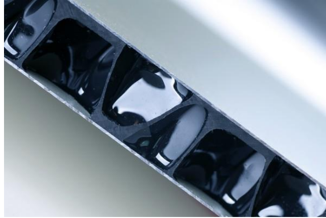
Resim 2. 18 Aluben alüminyum panel kesit fotoğrafı. Polikarbonat petek panel üstüne 0.5mm kalınlığında alüminyum kaplamasına ait detay (URL 20).
