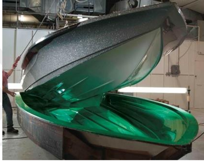
Resim 2. 12 Dişi kalıptan çıkan kompozit konstrüksiyonlu gövde. Yapılacak olan teknenin 1-1 prototipi olan erkek kalıptan elde edilen dişi kalıptan kompozit konstrüksiyonlu gövdenin çıkartılması aşamasına ait fotoğraf (URL 14).
