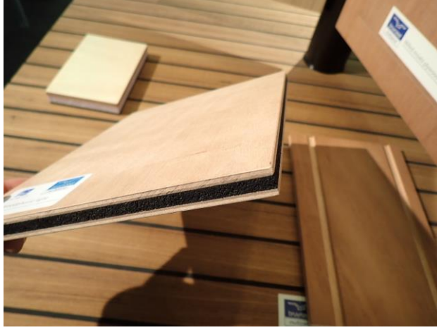
Resim 2. 22 Dolgu içerikli sandviç panel. Fotoğrafta Bryunzeel marka kauçuk dolgu içerikli sandviç panel bulunmaktadır. Panel ses izolasyonu sağlama özelliğine sahiptir. Fotoğraf 2017 yılında Hollanda’da düzenlenen RAI METSTRADE fuarında çekilmiştir (Yazar arşivi, 2017).
