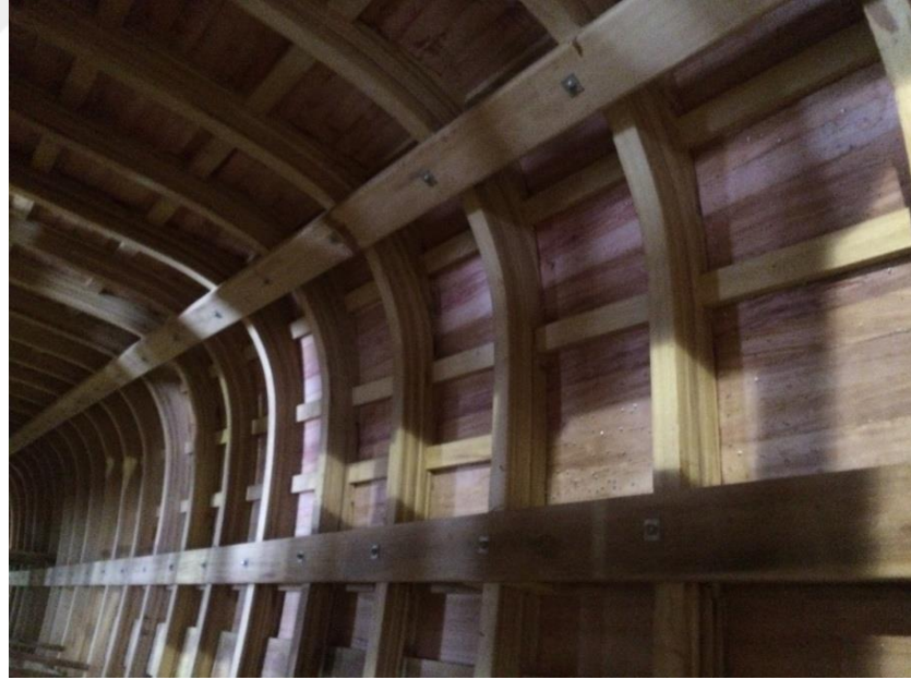
Resim 2. 7 Ahşap strüktür gövdeye içten bakış. Ahşap konstrüksiyonlu teknenin iskeletini oluşturmada kullanılan boyuna elemanlar olan postalar ve postaların darbelere karşı daha dayanıklı olmasını sağlayan şiyer kuşağı detayına ait fotoğraf. Fotoğrafın çekildiği aşamada strüktürü tamamlanan teknede armuz sistemi ile konstrüksiyon oluşturulmaktadır. Fotoğraf İstanbul Tuzla’da bulunan Tansu Yatçılık’ta çekilmiştir (Yazar arşivi, 2018).
