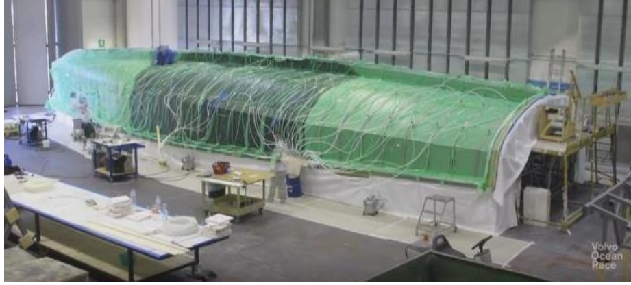
Resim 2. 14 Vakum infüzyon üretim tekniğinde reçine verim aşaması. Farr Yacht Design tarafından infüzyon tekniğiyle yapılmakta olan karbon kompozit konstrüksiyonlu yata ait fotoğraf. Fotoğrafta yeşil vakum torbası içerisinde bulunan kalıba borularla reçine verilmektedir. Koyu yeşil görünen bölüme reçine gitmiştir. Diğer yerlere de oradan ilerleyerek yayılmaktadır (URL 16).
