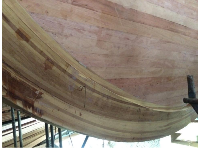
Resim 2. 10 Kıç tarafında ana omurga bağlantısı. Fotoğrafta Tuzla’da bulunan Tansu Yatçılık’ta yapımı süren ahşap teknede, armuz sistemi uygulanarak oluşturulan 3 katmanlı ahşap konstrüksiyondaki üçüncü kaplama katı ve ana omurganın baş kısmı görülmektedir. Fotoğrafta görüleceği üzere üçüncü kattaki birinci ve ikinci kattakilerden farklı olarak su hattına paralel olarak döşenmiştir. Ana omurga ise, baş ve kıç taraflarda en kalın olduğu boyutta olmakta, orta kısımlarda incelmektedir (Yazar arşivi, 2018).
