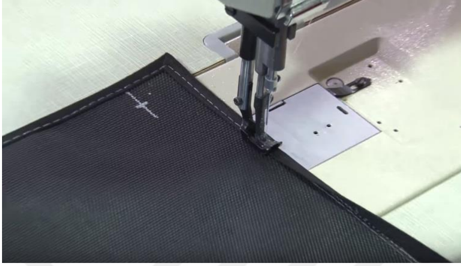
Resim 2. 65 Kumaşın kullanım yerindeki dayanımını arttırmak için kenarlarını koruma amaçlı biye dikimi (URL 73).
