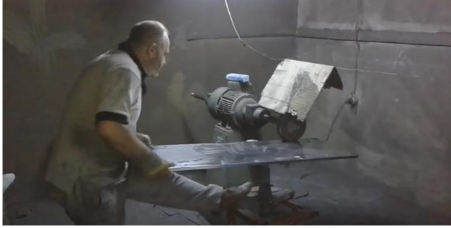
Resim 2. 53 Polisaj yapımı (parlatma). Çeşitli işlemlerden geçerek form verilmiş malzemenin üzerinde bulunan çizikleri mikron hassasiyetinde çizgiler kalıncaya kadar aşındırma işlemine polisaj denir. Amaç pürüzsüz ve parlak bir yüzey ortaya çıkarmaktır. Polisaj işleminde aşındırıcı olarak polisaj zımpara kağıdı kullanılmaktadır (URL 57).
