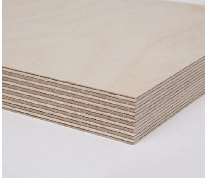
Resim 2. 21 Marin kontrplak. Fotoğrafta görüleceği üzere marin kontrplak oluşturulurken üst üste dizilen papeller birbirlerine ters yöndedir (URL 26).
