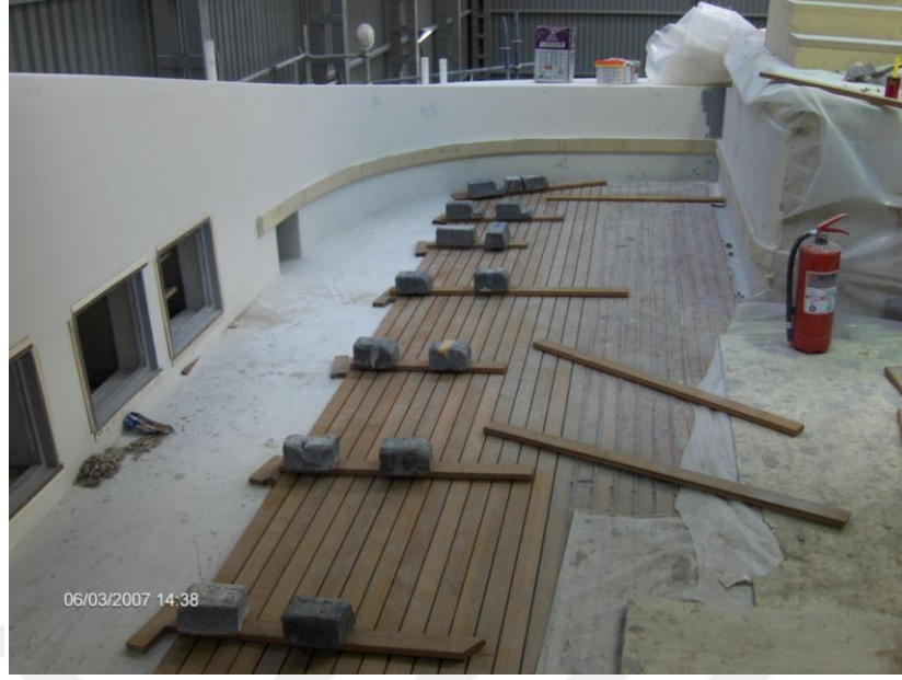
Resim 2. 34 Tik Ağacı'ndan yapılma masif parçaların güverte bölümüne döşenme aşaması (Sarıkaya, 2007).
