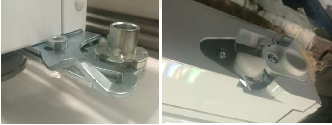
Şekil 21: Mevcut uygulamadaki menteşe ve kapı altında pim görüntüleri
