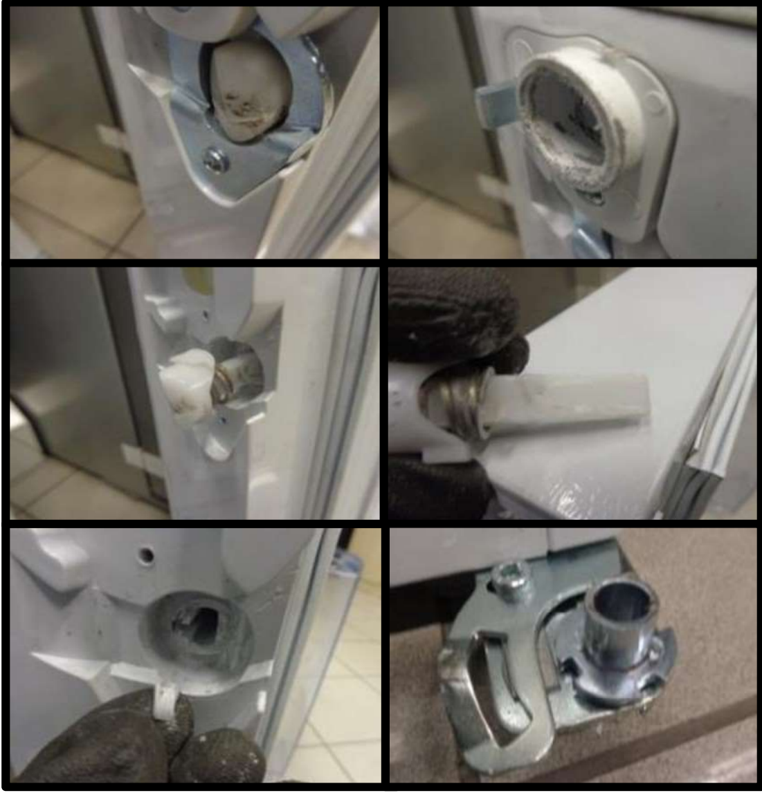
Şekil 78: Mukayese meaknızma parçaları ömür testi 250.000 çevrim sonu
