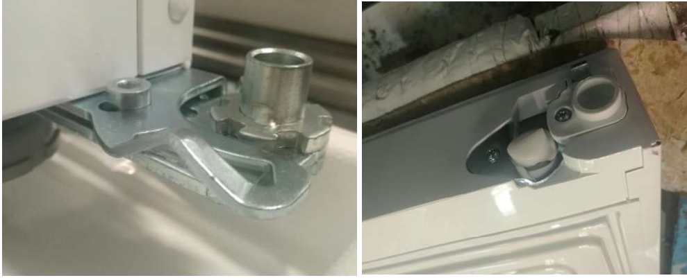
Şekil 76: Mukayese meknizma parçaları ömür testi öncesi görünüşleri
