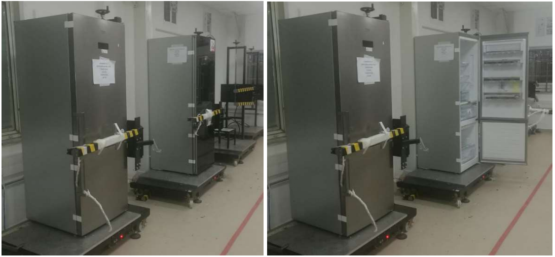
Şekil 72: Kapı açma kapama deneyi düzeneği
