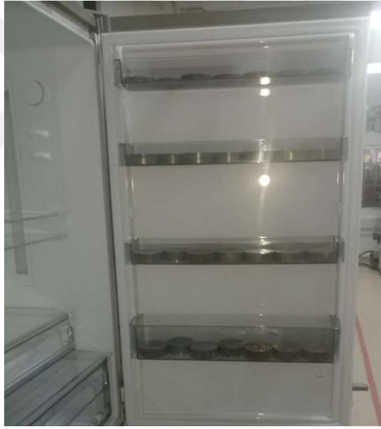
Şekil 73: Buzdolabı kapısı raflarının ağırlıklar ile yüklenmesi
