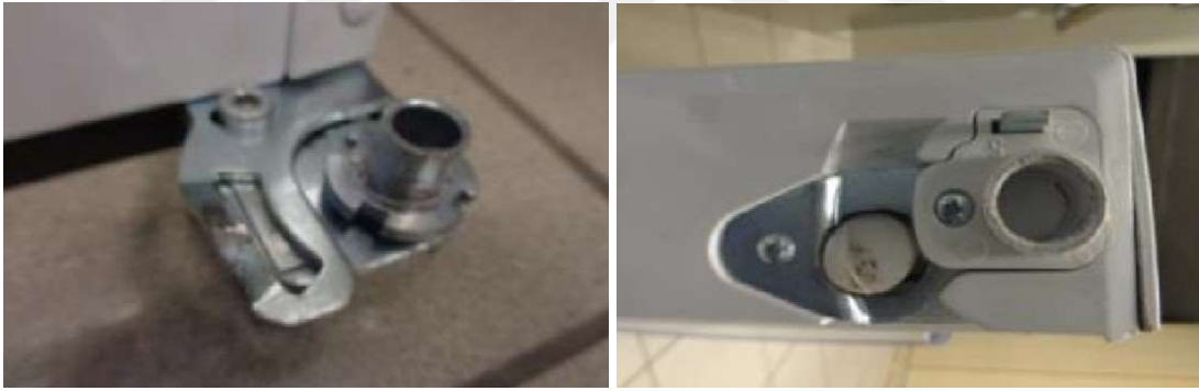
Şekil 77: Mukayese meknizma parçaları ömür testi 100.000 çevrim sonu
