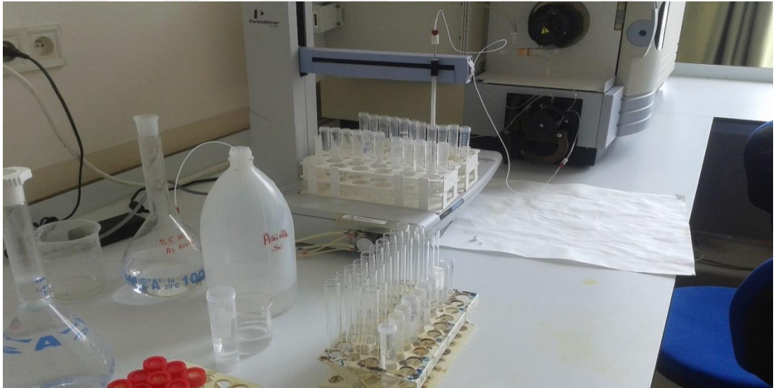
Şekil 4.2: Örnekleme noktalarından alınan numunelerin ICP cihazı ile ağır metal tayini.
