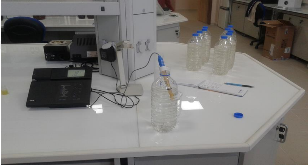
Şekil 2.2: Örnekleme yapılan numunelerin ph ve tuzluluk oranı ölçümü.
