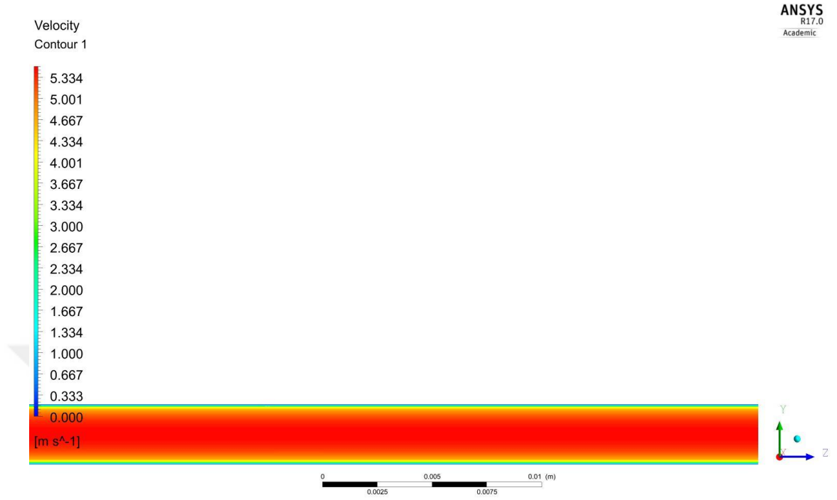
Şekil 4.16. 2,74 mm mini kanalda v=4,71 m/s olduğunda kanal çıkışında hız değişimi
