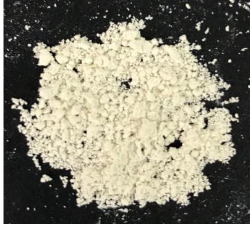
Şekil 4.8. Elektropüskürtme yöntemiyle %14 zein konsantrasyonu, 15 kV voltaj, 15.5 cm mesafe, 0.55 mL/sa çekirdek akış hızında elde edilen küresel ve homojen morfolojiye sahip partikülün toz görüntüsü
