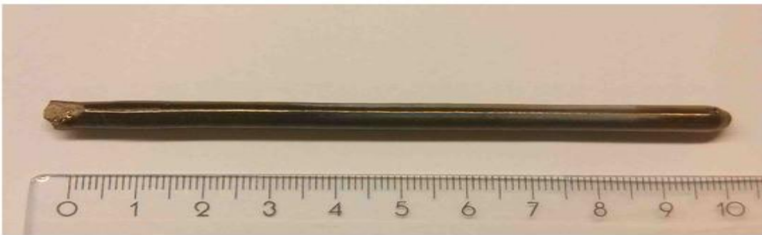
Şekil 3.3. \text{Bi}_{1,6}\text{Pb}_{0,4}\text{Sr}_2\text{Ca}_3\text{Cu}_4\text{O}_{12} ’un çubuk formunda üretilen durumu.
