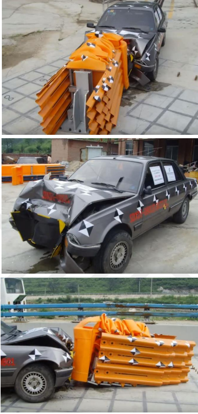
Şekil 2.7 : Çarpma yastığına 1500 kg ağırlığındaki aracın 80 km/sa hızla çarpması durumunda ortaya çıkan hafif hasar [6].
