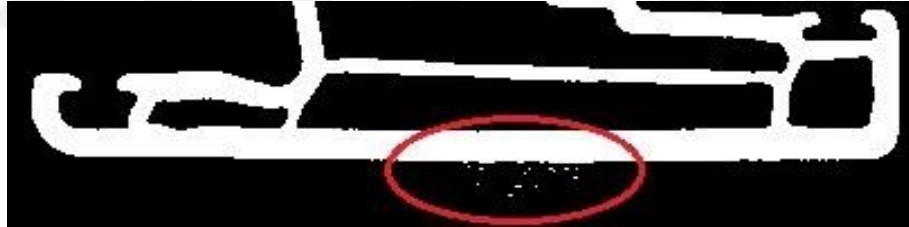
Şekil 4.5. Gaussian filtre uygulanmış pvc profil görüntüsü
