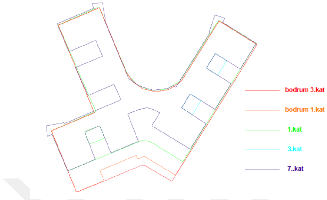
Şekil 6. 6: Katlar arası çekilmeler (döşeme düzensizlikleri).
