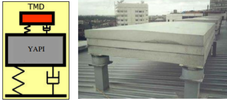
Şekil 3. 16: Ayarlı kütle sönümleyici mekanik modeli.
