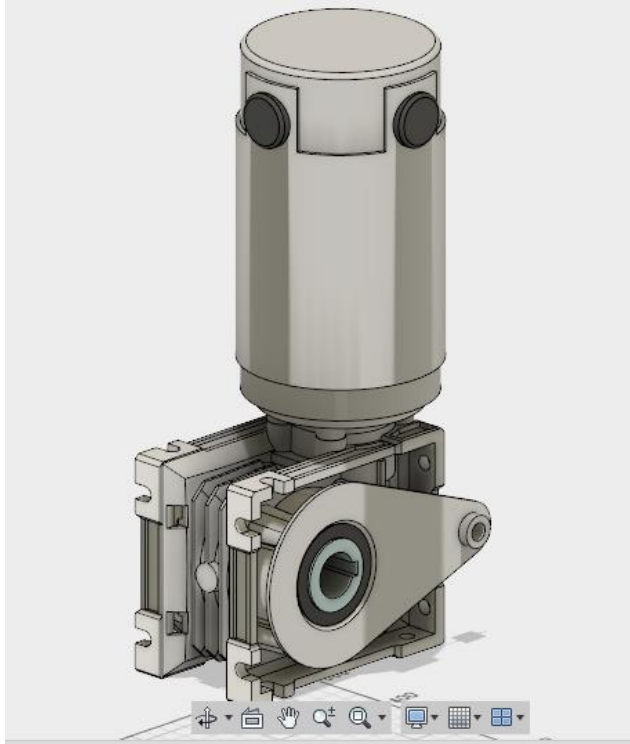
Şekil 4.7. Ana motor ve 60/1 oranına sahip dişli kutusu bağlantısı
