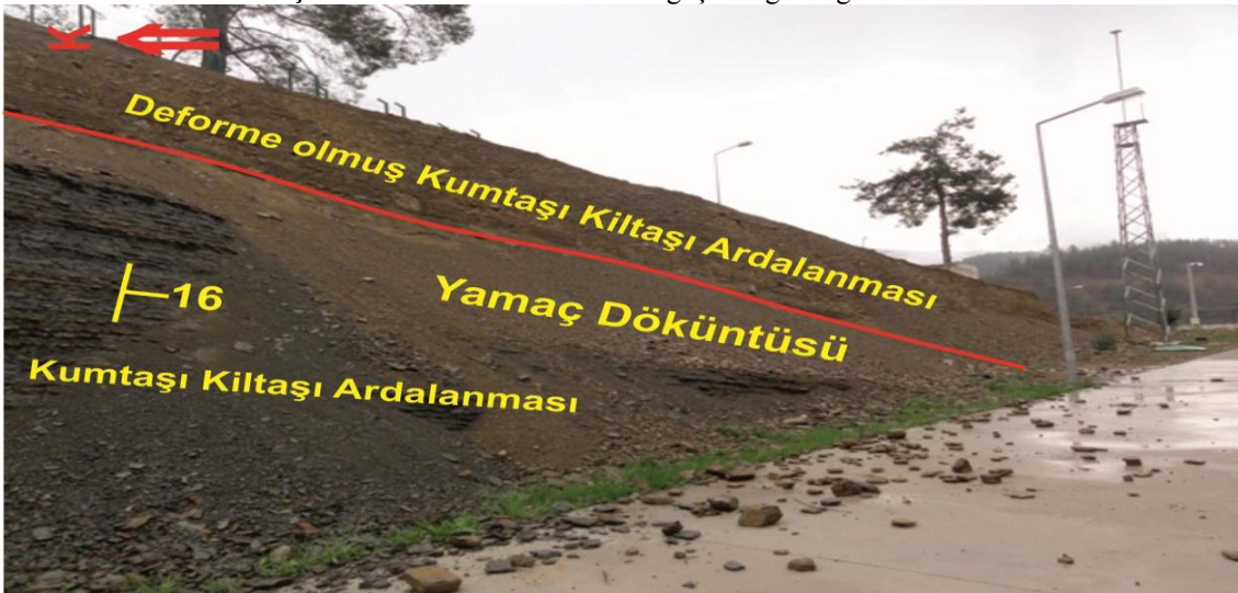
Şekil 3.17. B-B' kesitinde tabakaların konumu ve yamaç boyunca oluşan döküntülerin görünümü
