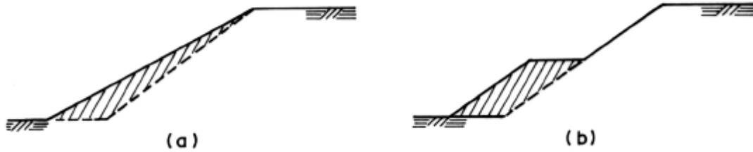
Şekil 2.13. Stabilitenin şev üzerinden yük kaldırılması yoluyla sağlanması a) Şev tepesinden kütle kaldırılması, b) Şev yüzeyinden kütle kaldırılması, c) Şev üzerinden basamak teşkil edecek şekilde kütle kaldırılması, d) Şev kesitinde üst tabakanın daha kuvvetli olması durumunda tabakalara farklı eğimler verilmesi (Huvaj 2017)
