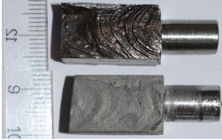
Şekil 4.30 Çitomangan dolgu tabakalı aşınma yapılmamış (üstte) ve aşınma sonrası (altta) numuneler.
