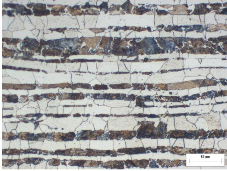
Şekil 4.7 Sıvı nitrürlü numunenin ana malzemesi 200x büyütmede mikro yapısı.
