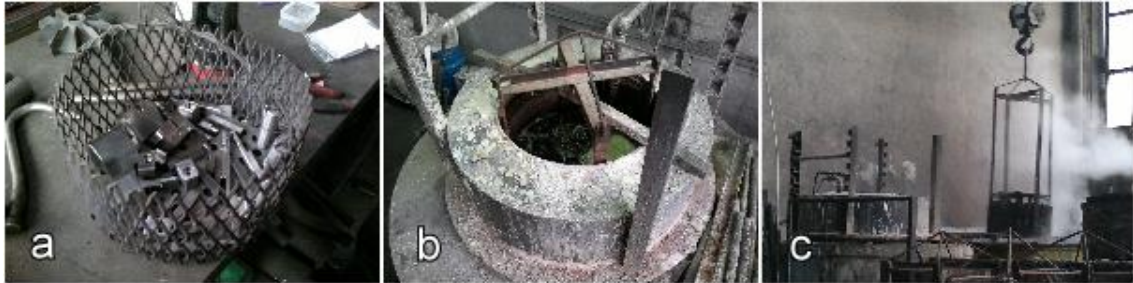
Resim 3.1 a) Malzemelerin sepete yerleştirilmesi b) Malzemelerin tuz banyosuna daldırılması c) Malzemelerin soğutma işlemi.
