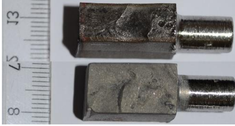
Şekil 4.29 EIS 410 NiMo dolgu tabakalı aşınma yapılmamış (üstte) ve aşınma sonrası (altta) numuneler.
