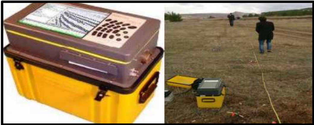
ekil 3.11 Geometrics Smart Seis 12 cihazı ve alı ma alanından bir görüntü (ReMi)
