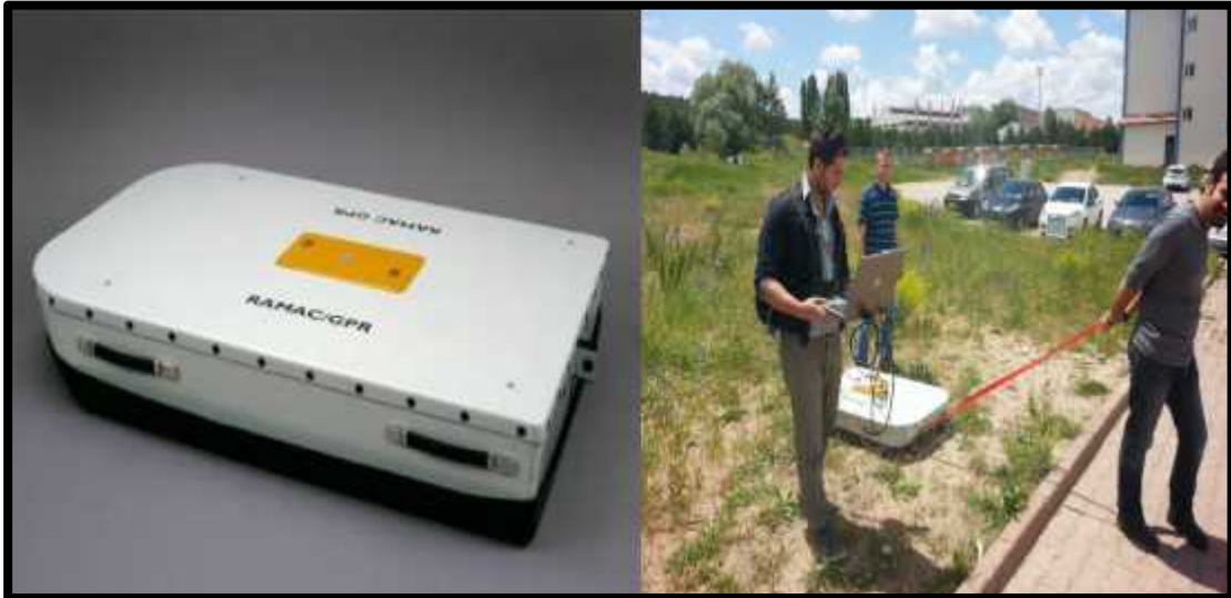
ekil 3.13 Mala-Ramac 100 MHz kapalı (shielded) anten cihazı ve çalıştırma alanından bir görüntü
