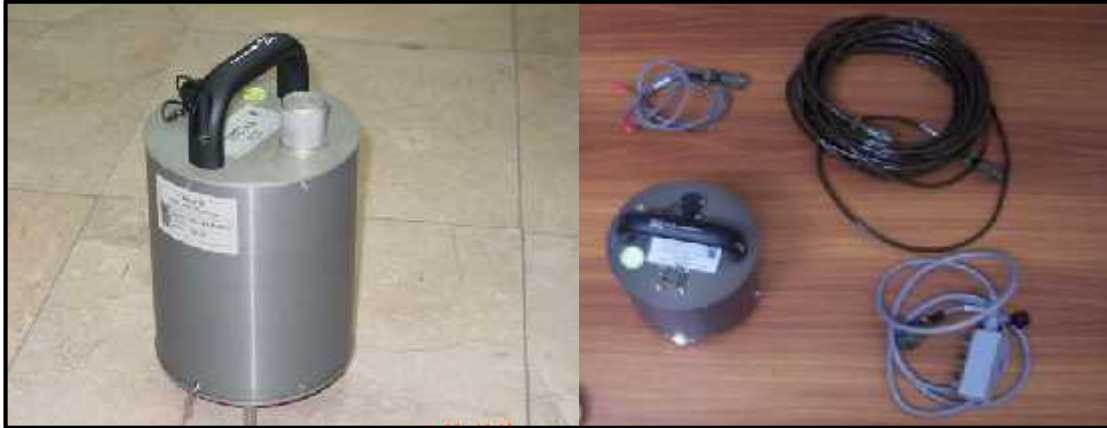
ekil 2.4 Mikrotremor ölçümleri için kullanılan geniş bant aralıklı üç bileşenli sismometre ve ölçüm düzeni
