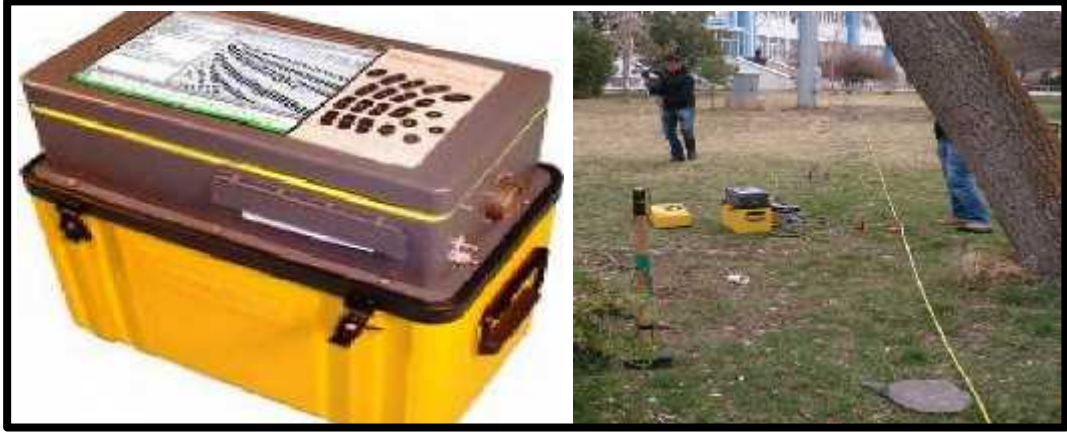
ekil 3.9 Geometrics Smart Seis 12 cihazı ve alı ma alanından bir görüntü(MASW)
