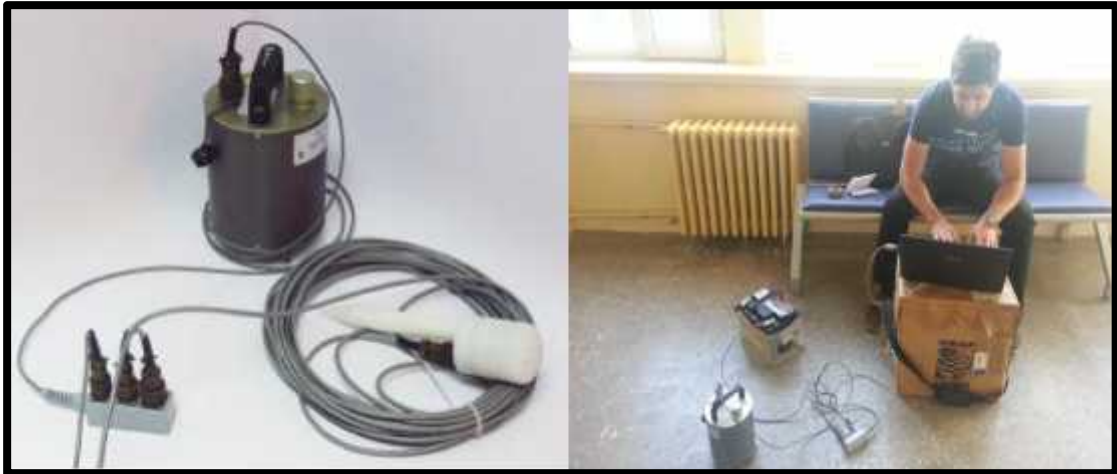
ekil 3.4 Guralp CMG-6TD mikrotremor cihazı, ekipmanlar ve çalı ma alanından bir görüntü
