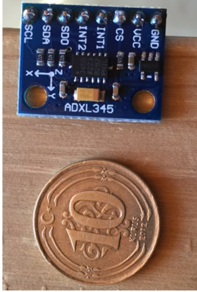
Şekil 3.7 : Kalp seslerinin elektriksel sinyale dönüştürülmesi için kullanılan ivme sensörü.
