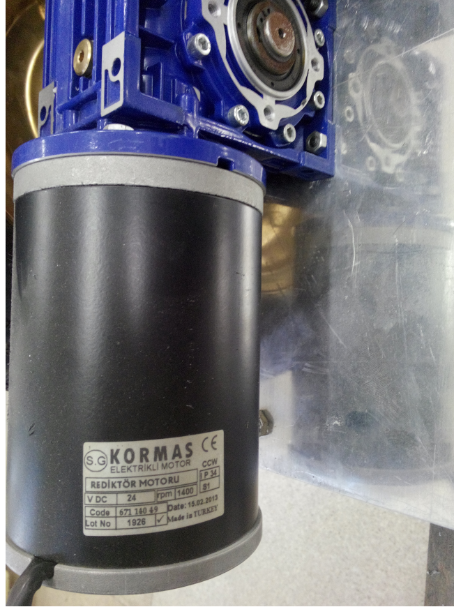
Şekil 4.5: Kormas marka 24 v fırçalı dc motor.
