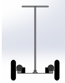
Şekil 4.2: Kendini dengeleyebilen iki tekerlekli elektrikli aracın katı modelinin arkadan görünüşü.
