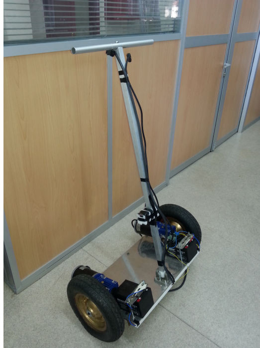
Şekil 4.16: Kendini dengeleyebilen iki tekerlekli aracın son hali.
