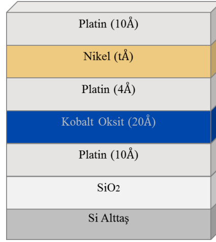
Şekil 5.1: Ni/CoO çok katlı ultra ince film yapısı.
