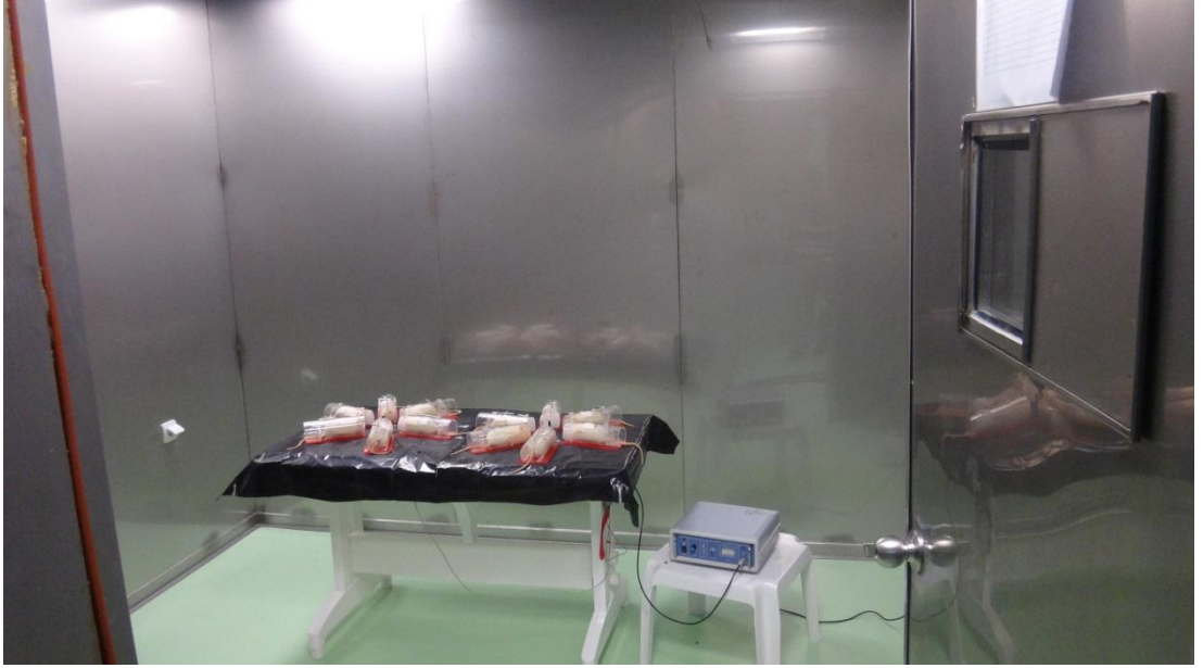
Resim 4. Çelik tabakalarla tamamen dış ortam radyasyonundan izole edilmiş çalışma odası ve RF oluşturan cihaz
