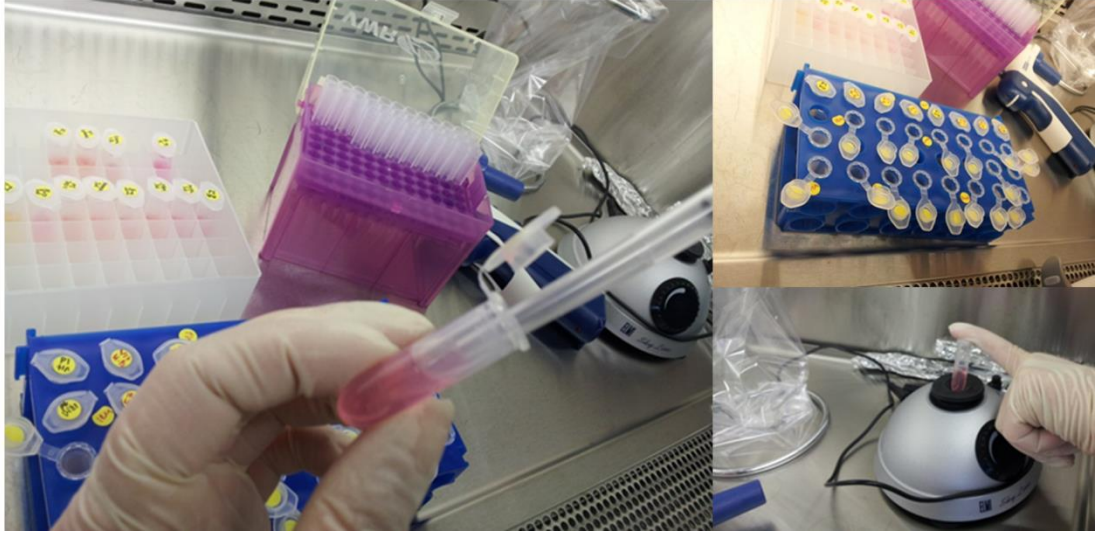
Resim 2.16. Materyal eluatlarının dilüsyonu 1/2, 1/4, 1/8’lik konsantrasyonlarının hazırlanması
