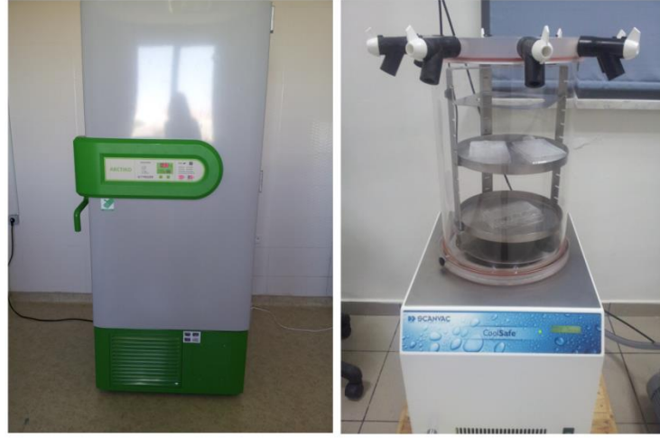
Resim 2.40. Örneklerin -80^{\circ}\text{C} 'de saklandığı dondurucu ve Liyofilizatör
