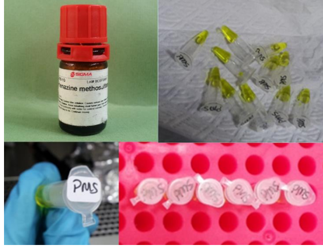
Resim 2.21. PMS tozu ve 1,53 mg/ml PMS'nin hazırlanması
