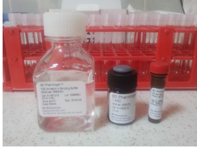
Resim 2.31. Flow sitometri kiti; Baęlanma tamponu, 7AAD boyası ve Annexin V boyası
