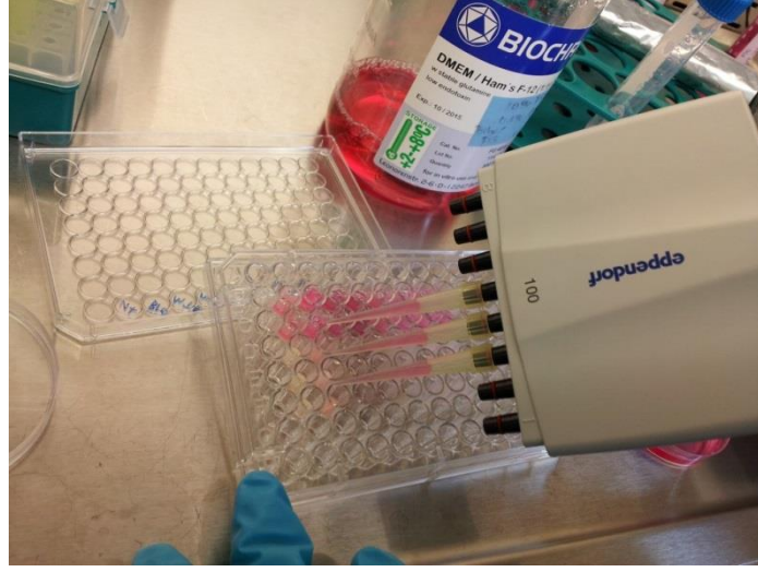
Resim 2.36. SEM analizi için materyal diskleri üzerine hücre süspansiyonunun eklenmesi
