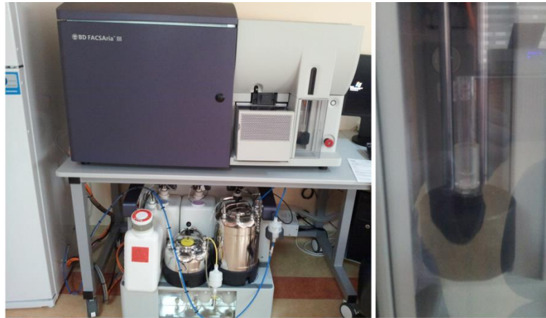
Resim 2.33. Flow sitometri cihazı ve örnek yerleştirilen bölmesi
