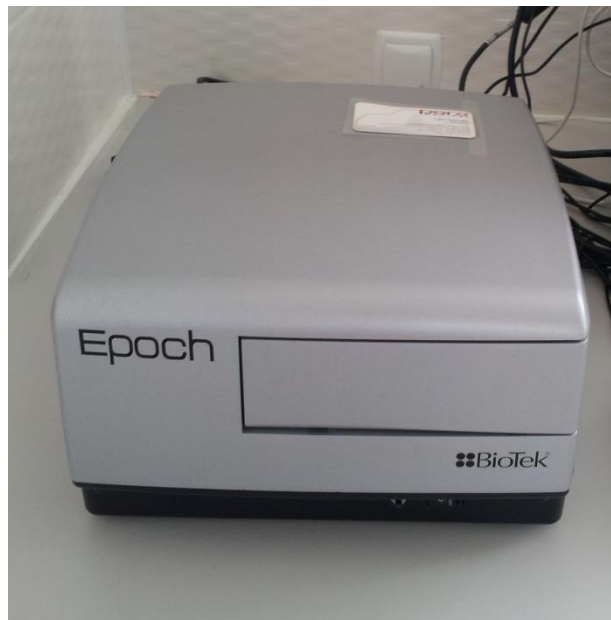
Resim 2.23. XTT solüsyonunun optik yoğunluğunun ölçümünde kullanılan spektrofotometrik okuyucu
