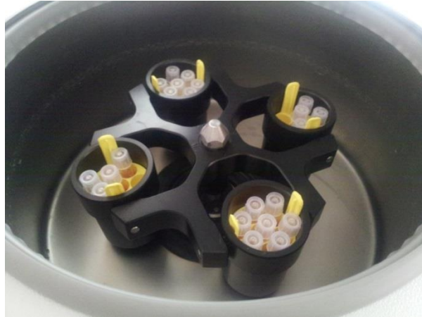
Resim 2.30. Santrifüj cihazına yerleştirilen flow tüpleri
