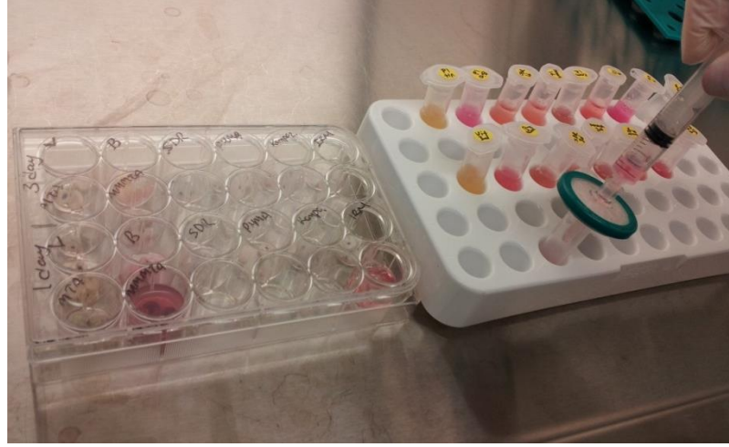
Resim 2.14. Materyal eluatlarının filtreden geçirilmesi
