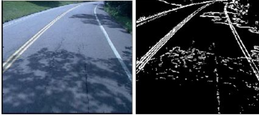
Şekil 2.6. Çekilen bir yol resmi ve filtreden geçirilmiş hali
