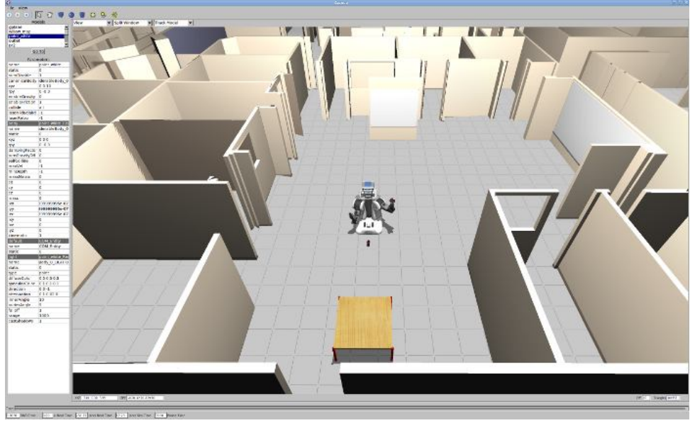
Şekil 3.3. Gazebo simülasyon ortamında modellenmiş bir ofis ve robot
