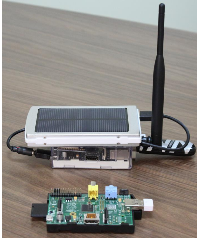
Şekil 3.14: Koordinatör: “Raspberry Pi” tek kartlı bilgisayar.
