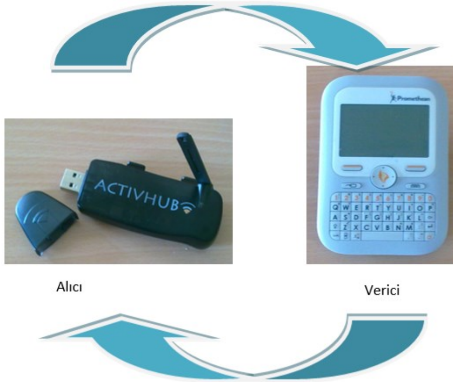
Şekil 3. Öğrenci Yanıtlama Sistemi Verici ve Alıcı İletişimi
