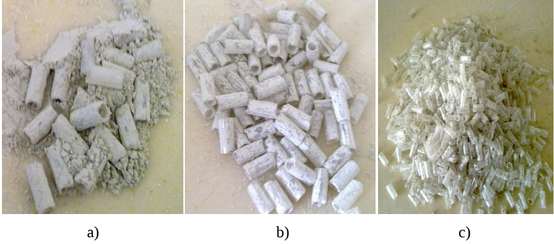
řekil 4.10. Destek materyalli cam borucuklu kolon dolgu maddesi hazırlama alıřmaları a) kil ile kaplanmış řekli, b) kil kaplamaların kopmaya bařlamıř řekli, c) kil kaplamaların kopmuř řekli.
