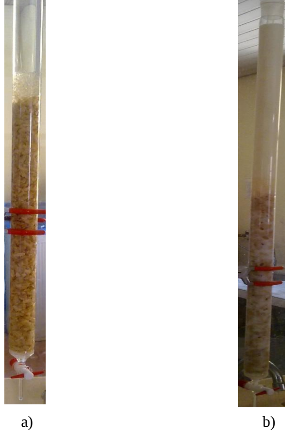
Şekil 4.13. Spiral çam kıymık ve kil-agar karışımı dolgulu olan destek materyalli cam kolonun saf su ve aflatoksinli süt ile muamelesi a) kolonun saf su ile muamelesi, b) kolonun aflatoksinli süt ile muamelesi.
