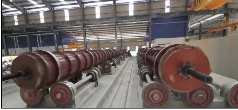
Şekil 3.22: Kazık betonun dökülmesinin hemen ardından gerçekleştirilen döndürme işleminin ikinci aşaması.
