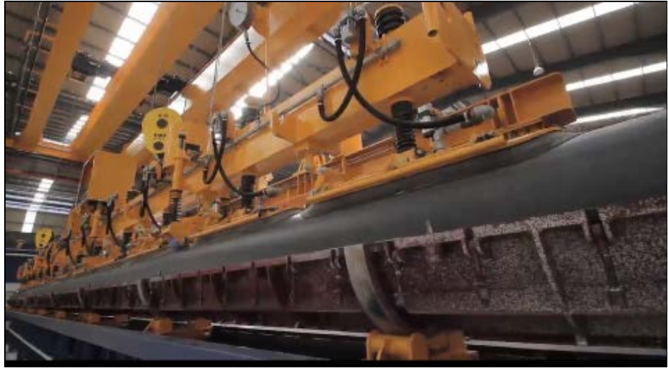
Şekil 3.27: Kazığın vakumlu ekipman yardımıyla kalıptan çıkarılması.
