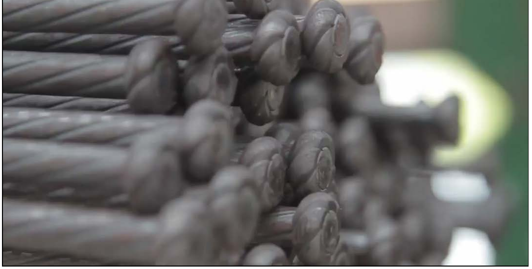
Şekil 3.7: Kazık boyuna donatısının uçlarının, ankraj plakasına sabitlenebilmesi için şekillendirilmesi.
