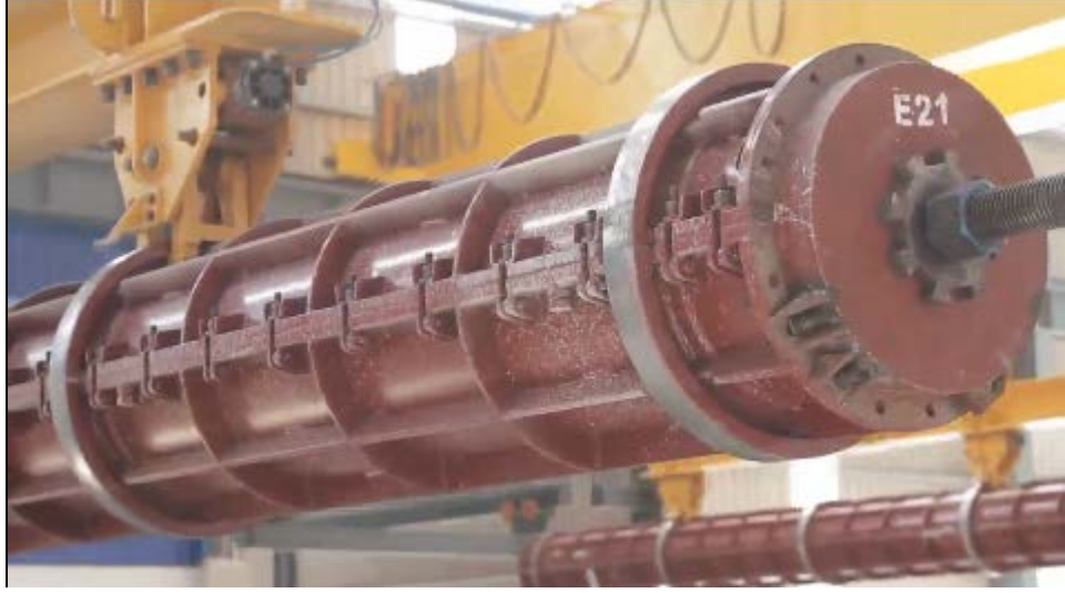
Şekil 3.20: Kazığın döndürme makinesine taşınması.
