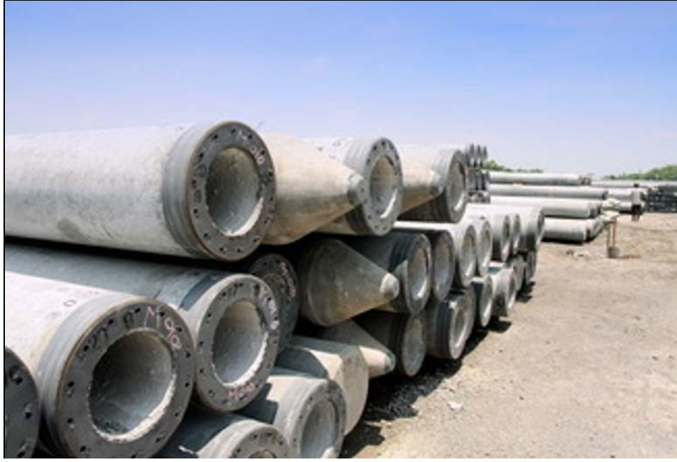
Şekil 3.32: Kazık başlarının proje özelliklerine göre çakım kolaylığı için tasarlanmış başlıkları.
