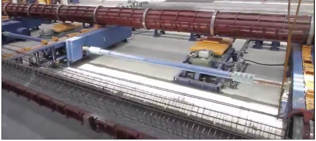
Şekil 3.12: Donatı kafesinin kalıplara yerleştirilmesi.
