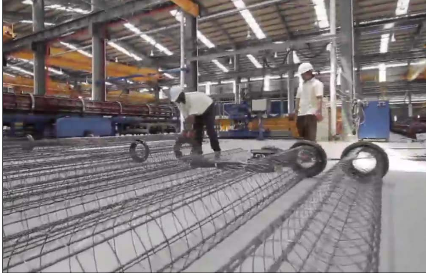
Şekil 3.10: Öngerme donatılarının başlık plakalarına sabitlenmesinin birinci aşaması.
