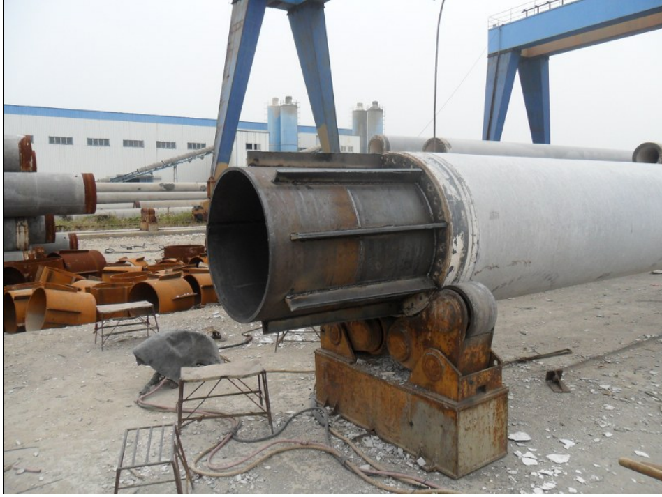
Şekil 3.34: Kazıkların birbirine eklenebilmesi için kullanılan ilave parça.
