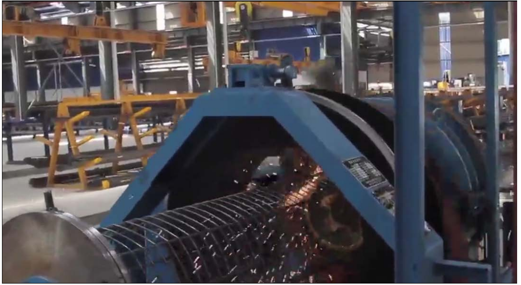
Şekil 3.8: Kazık donatı kafesinin özel makine yardımıyla hazırlanmasının birinci aşaması.
