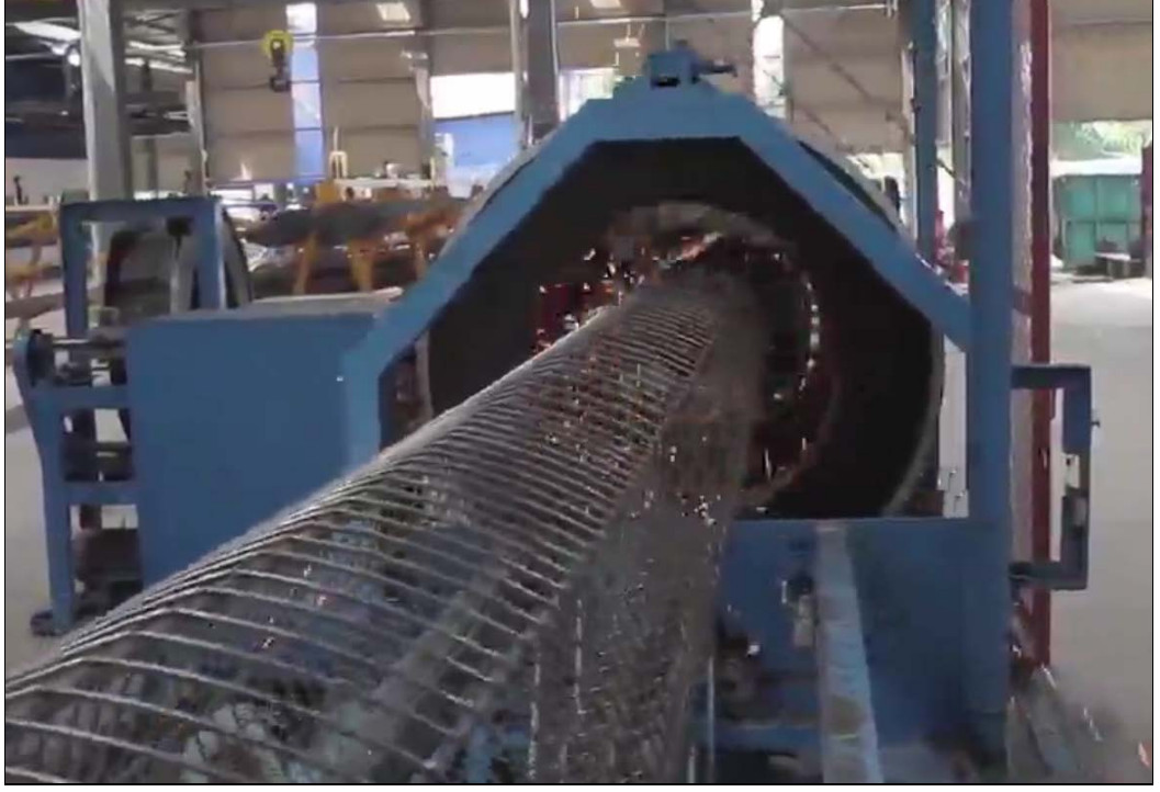
Şekil 3.9: Kazık donatı kafesinin özel makine yardımıyla hazırlanmasının ikinci aşaması.
