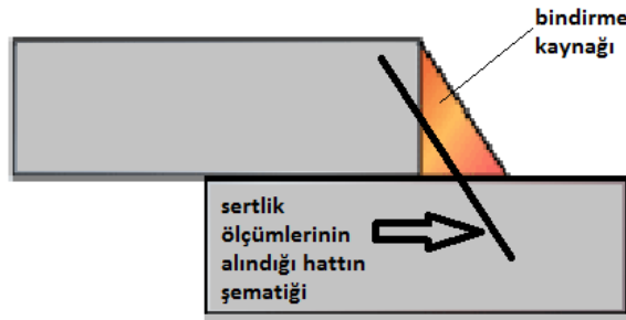
Şekil 5.3. Uygulanan mikrosertlik ölçümünün şematığı.
