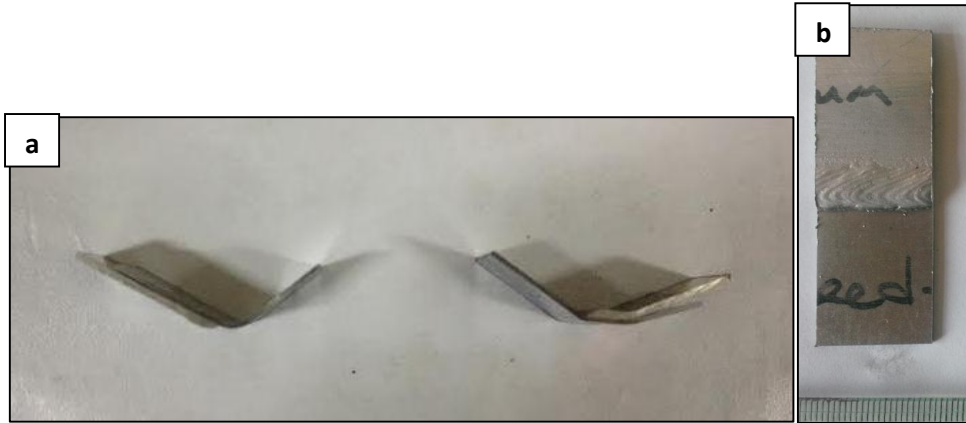
Şekil 6.18. (a) Eğme testi numunesi. (b) Eğme testi sonucu numune görüntüsü.
