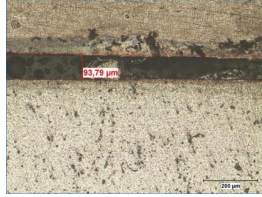
Şekil 6.24. 1050 Alüminyum ve 1314 galvanizli sac arasındaki birleşme aralığı.
