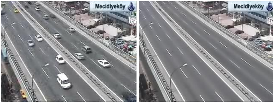
Şekil 2.13. t anında çekilen çerçeve ve arka plan (Tamersoy 2009)
