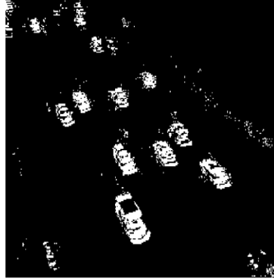
Şekil 2.14. Arka plan çıkarılmış çerçeve (Tamersoy 2009).
