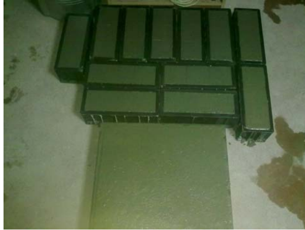
Fotoğraf 5.2. Taze betonların kalıplara yerleştirilmiş hali
