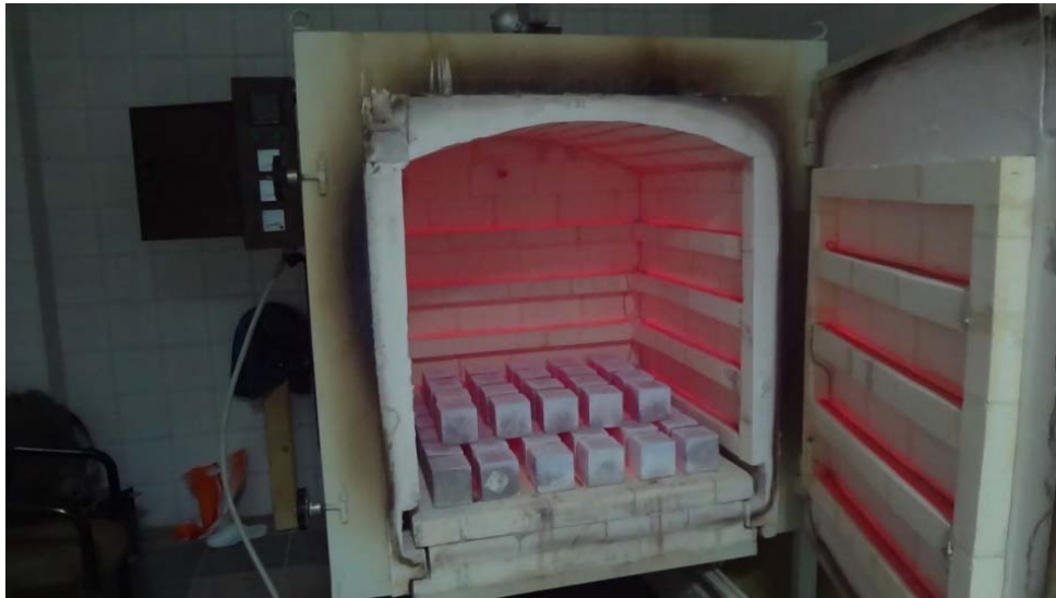
Fotoğraf 5.5. Deney numunelerinin yüksek sıcaklığa maruz bırakılması
