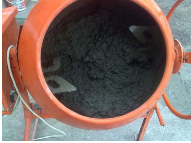
Fotoğraf 5.1. Taze betonun hazırlanması
