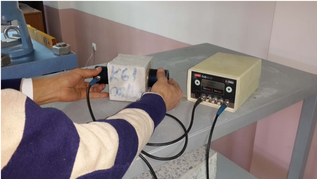
Fotoğraf 5.6. Numunelerin ultrases geiş hızının belirlenmesi
