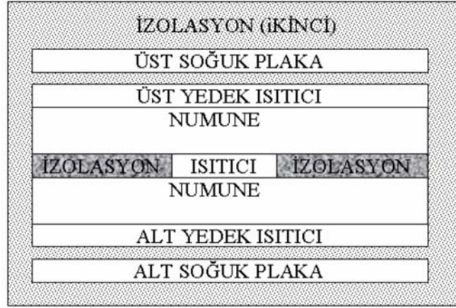
Şekil 4.3. Plaka yöntem cihazı (ASTM C177, 1985)
