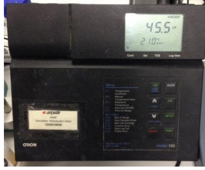
Şekil 3.15 : İletkenlik ölçüm cihazı.
