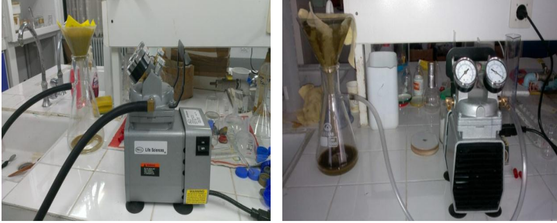
Şekil 3.11 Aşı çözeltisinin filtre edilerek, kullanıma hazır hale getirilmesi
