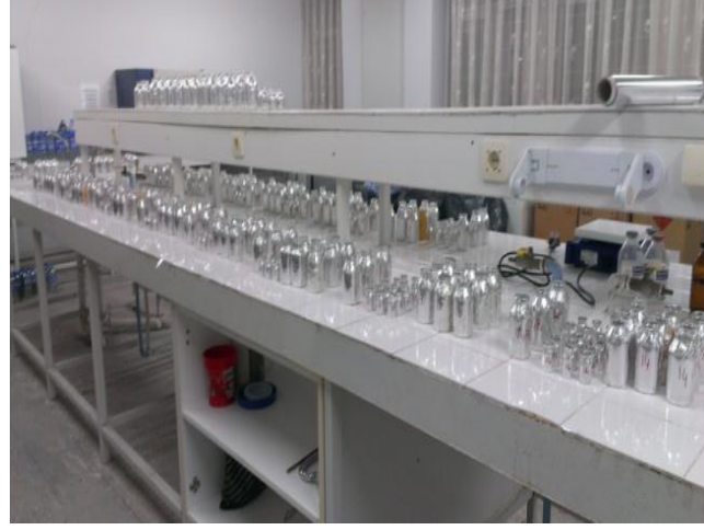
Şekil 3.9 Anaerobik işlem için serum şişelerinin hazırlanması
