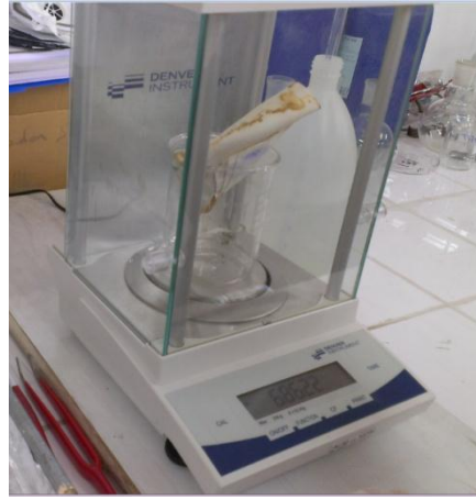
Şekil 3.6 Numunelerin suda çözünme işleminden sonra tartılması
