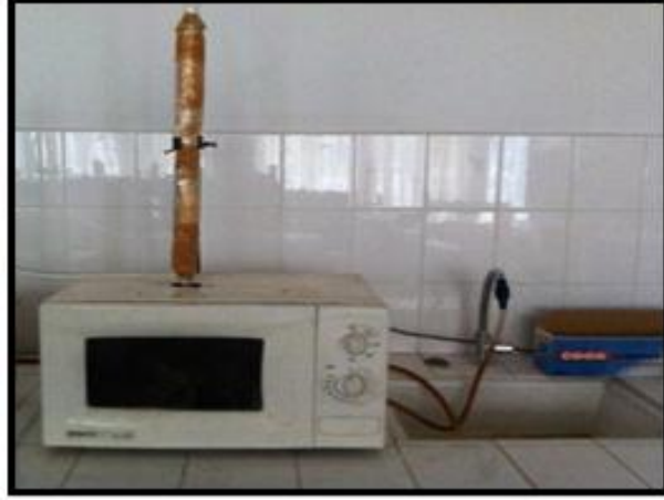
Şekil 3.4 Mikrodalga ön işlem düzeneğinden bir görünüş
