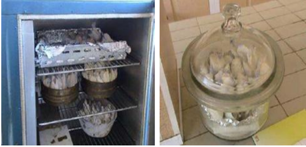
Şekil 3.5 Sulu faza geçmeyen katı kısmın etüvde kurutulması ve etüvden çıkartılan örneklerin tartılmadan önce desikatörde soğutulması
