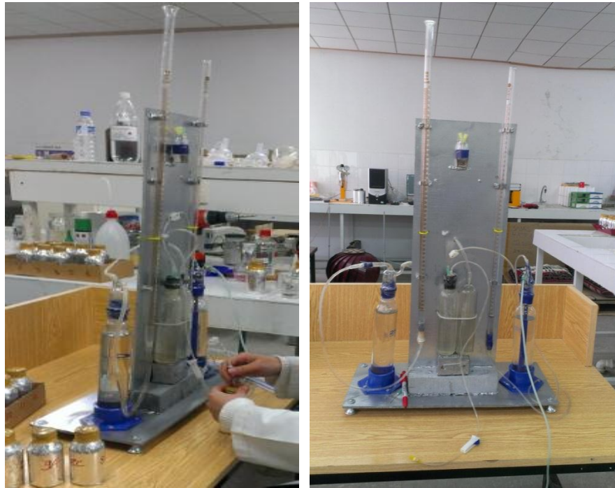
Şekil 3.15 Biyogaz ve metan ölçümünde kullanılan Orsat tipi gaz ölçüm aleti
