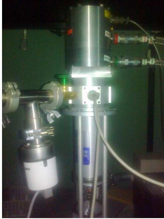
Resim 3.3. Kreostat , sensör ve silikon diyotun bulunduğu "closed cycle" sistemi.
