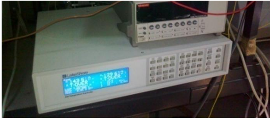
Resim 3.4. Lineer sıcaklık ayarlarını yapan Lakeshore cihazı..
