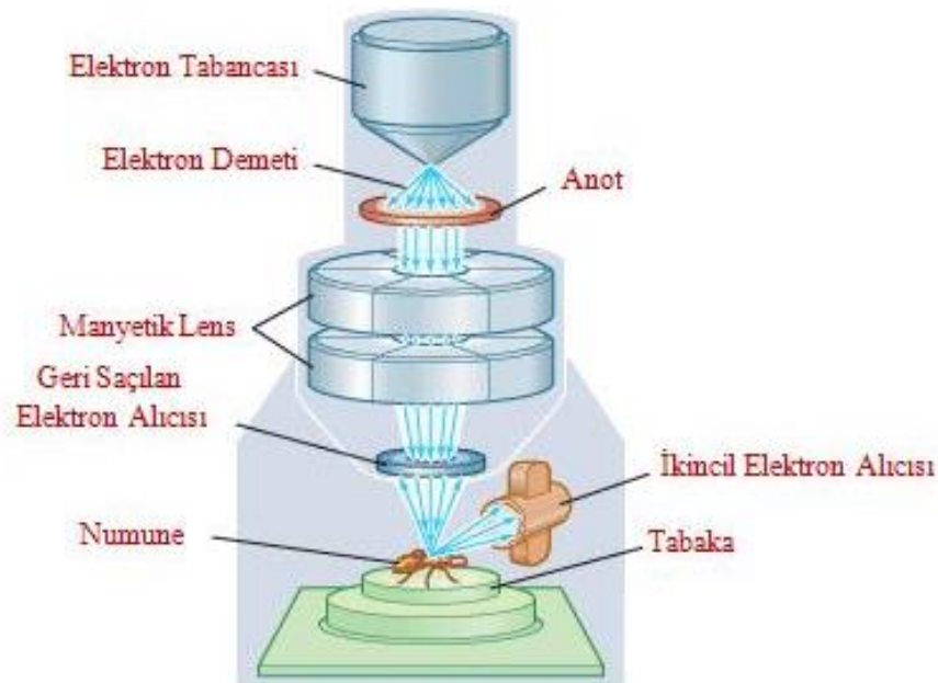
Şekil 2.48. SEM'in şematik yapısı (Anonymous 2013c)
