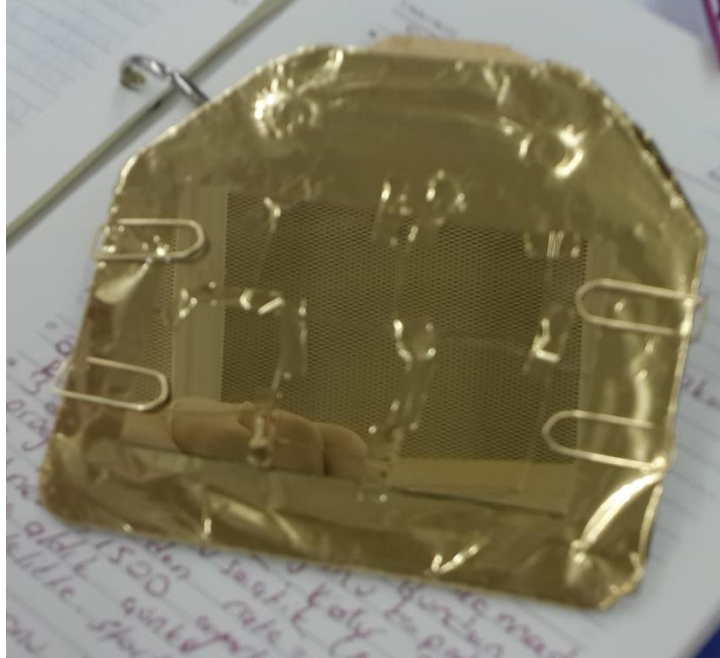
Şekil 3.11. Sputter cihazında önce titanyum daha sonrada altın kaplandıktan sonra silikon alttaşı
