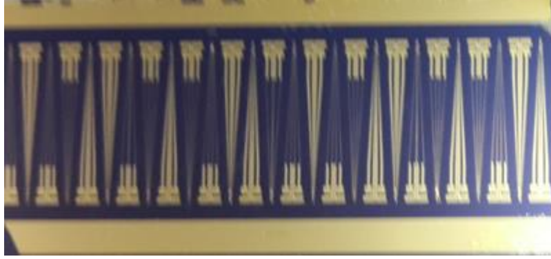
Şekil 3.12. Lift-off işleminden sonra silikon alttaş
