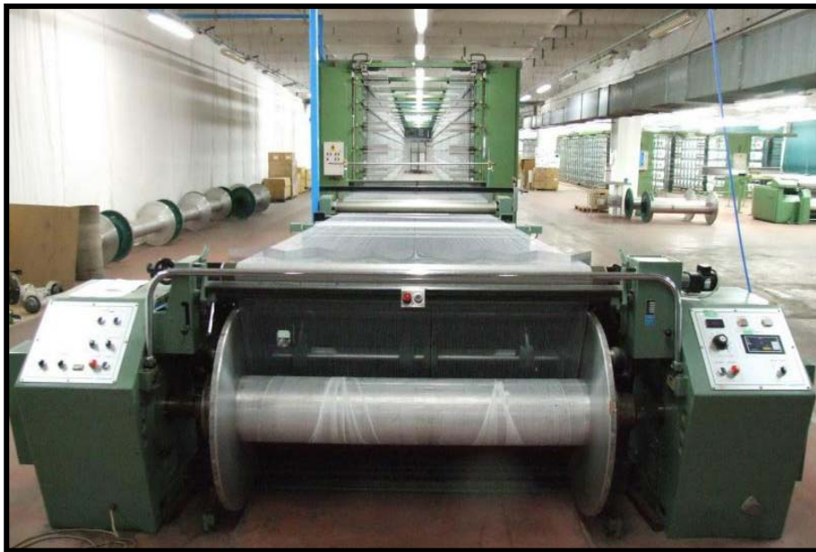
Şekil 21. Tsudakoma TW-N, seri çözgü makinesi ( http://www.wotol.com )
