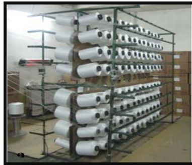
Şekil 70. a) Çözgü ipliği bobinlerinin desen ve renk sırasına göre yerleştirildiği çağlık, b) Çözgü iplikleri fren tertibatı ve iplik yoklayıcı (Meram tekstil, İstanbul)
