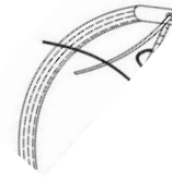
Şekil 123. Atkı iğnesi hareketi soldan sağa
