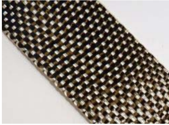
Şekil 66. Atkı ipliği karbon lifi, çözgü ipliği vectran® olan dar dokuma bant ( http://www.gueth-wolf.de )
