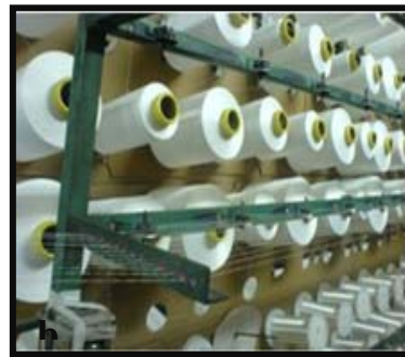
Şekil 70. a) Çözgü ipliği bobinlerinin desen ve renk sırasına göre yerleştirildiği çağlık, b) Çözgü iplikleri fren tertibatı ve iplik yoklayıcı (Meram tekstil, İstanbul)
