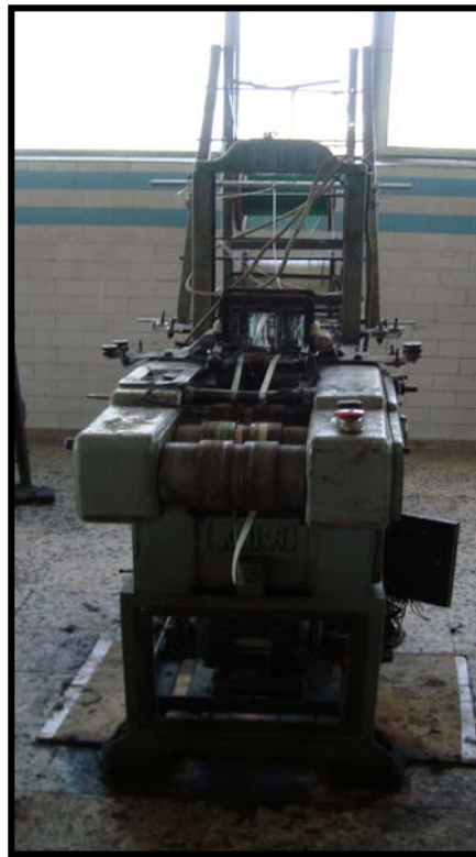
Şekil 114. Kuş dar dokuma makinesi (Durmaz, İstanbul)
