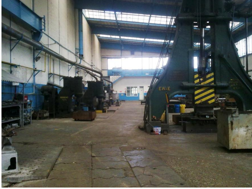
Şekil 4.7 400 ton basma kuvvetine sahip eksantrik pres.
