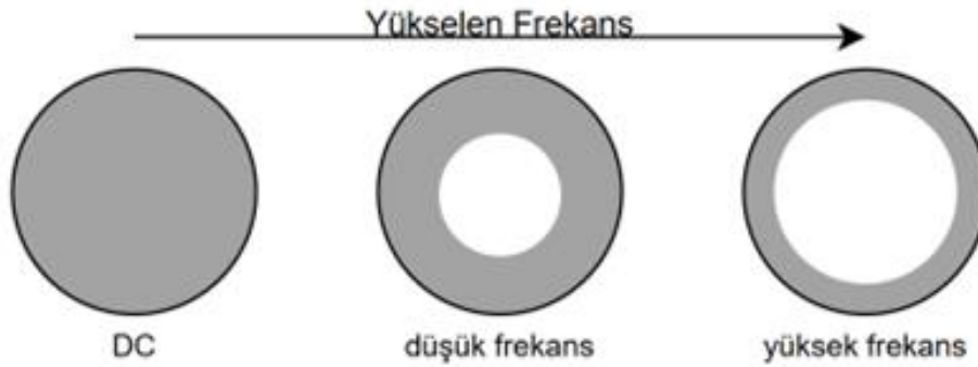
Şekil 2.10 Frekansa göre yüzey etkisinin kablo kesitindeki görseli
