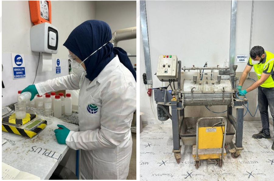
Şekil 3. 6. Tutkal karışımlarının hazırlanması ve yonga ile karıştırılması
