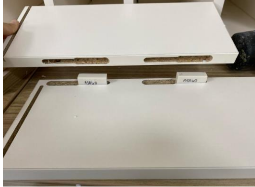
Şekil 3.7. L-tipi köşe birleştirmelerinin bağlantı elemanları ile montajı
