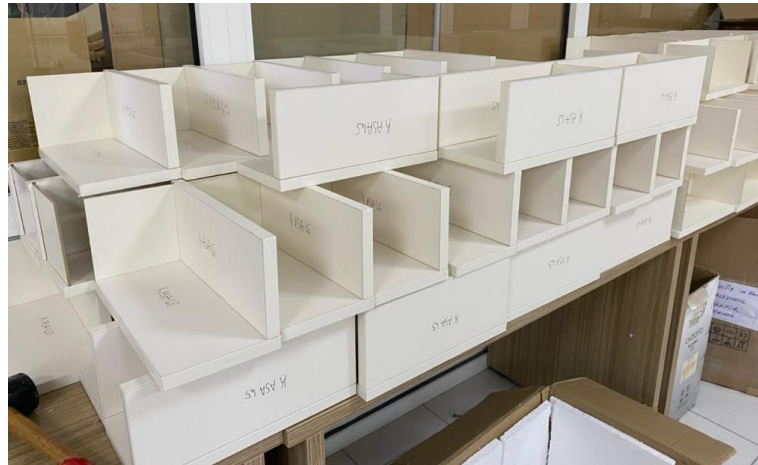
Şekil 3.9. Montajı tamamlanan ve test için hazır olan L-tipi köşe birleştirmeler
