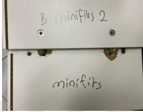
Şekil 4.5. Diyagonal basınç testlerinde H tipi, K tipi bağlantı elemanları ve minifiks bağlantı için deformasyon karakteristikler
