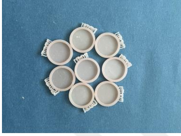
Resim 3.4. Üç boyutlu baskı yöntemiyle üretilen resin kalıplar
