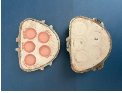
Resim 3.6. Mufla içerisine alçı dökülmesi
