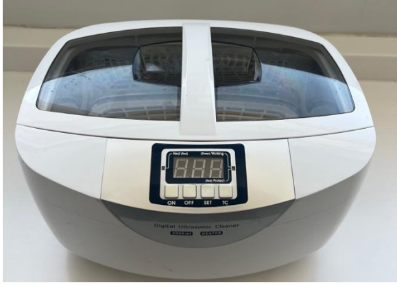
Resim 3.9. Silikon örneklerin ultrasonik temizleme cihazında temizlenmesi
