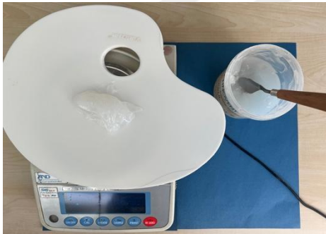
Resim 3.7. Hassas tartıda maksillofasiyal silikonlara ait katalizör baz oranının ayarlanması
