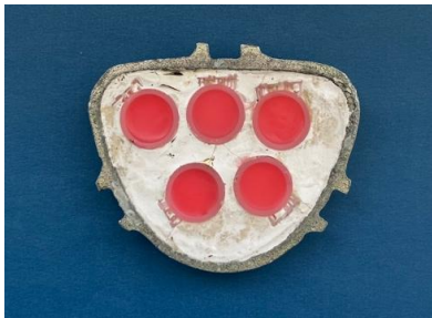
Resim 3.5. Üç boyutlu baskı resin kalıpların içerisine mum replikaların yerleştirilmesi
