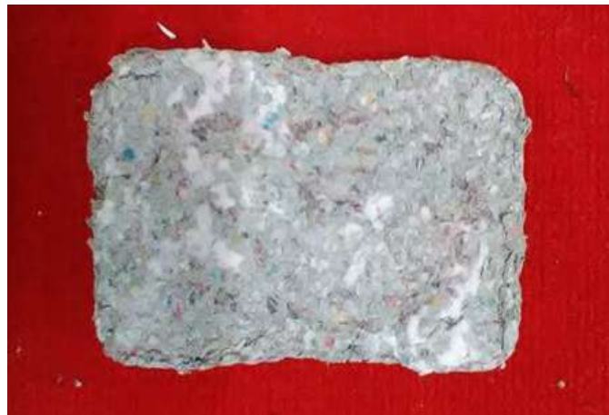
Şekil 4.27 Tutkal ile gevşek malzeme ile elde edilen sert malzeme [95], [96], [97]
