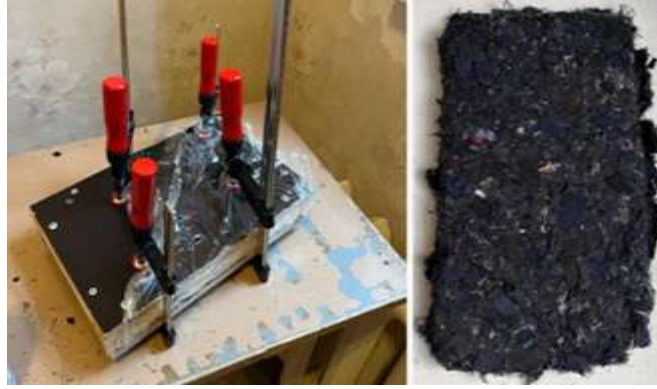
Şekil 4.7 Ahşap kalıp ile şekillendirilmiş malzeme [62]
