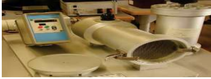
Şekil 4.93 Ses yutum katsayısı ölçümleri için Kundt Tüpü [146], [147]
