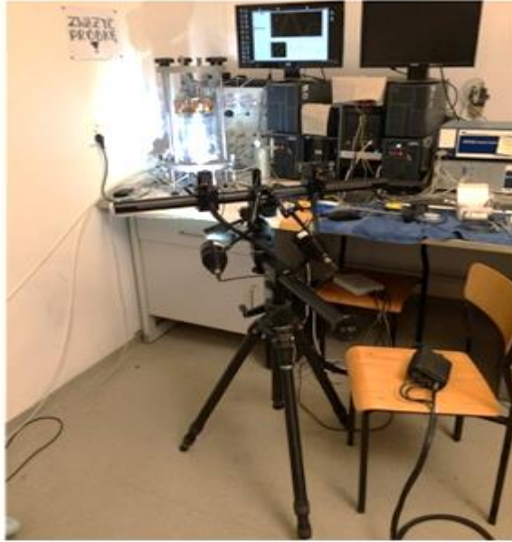
Şekil 1.3. Torsiyon kesme testinde kullanılan optik izleme düzeneği ve görüntüleme alanı, (Srokosz ve ark., 2021).
