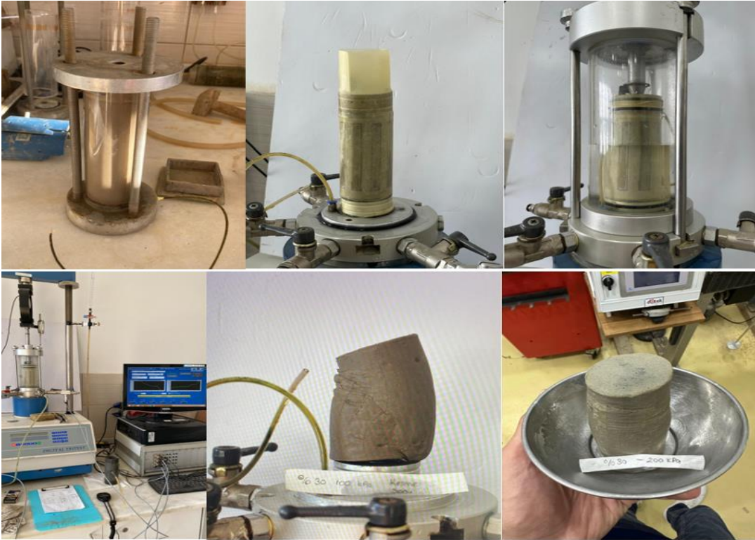
Şekil 4.2. Üç eksenli hücre kesme deneyi aşamaları (CU).
