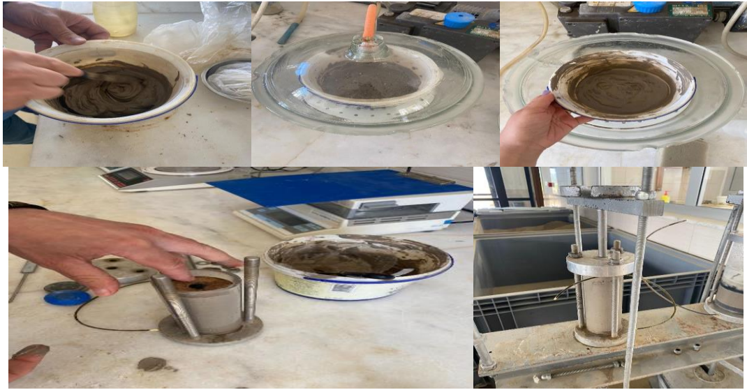
Şekil 4.1. Üç eksenli hücre kesme deneyi numune hazırlanması.
