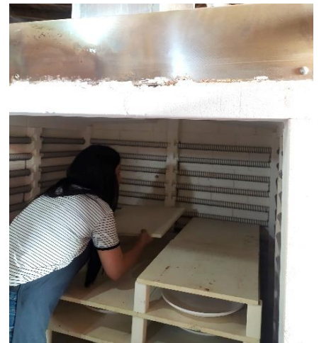
Görsel 56: Ümmühan Şimşek, Fırın rafının yerleştirilme işlemi
